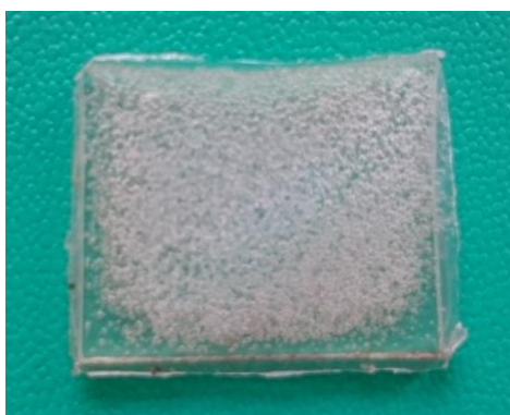
Εικόνα 4. 1: Πλακίδιο από PLLA μορφοποιημένο στην πρέσσα στους 200 °C για 7 min
