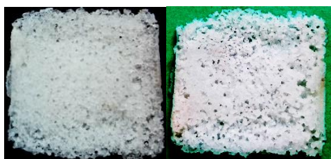
Δοκίμιο A: m_{\text{πριν}} = 0,4597\text{g} και m_{\text{μετά}} = 0,4569\text{g}
