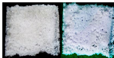
Δοκίμιο B: m_{\text{πριν}} = 0,4491\text{g} , m_{\text{μετά}} = 0,4448\text{g}
