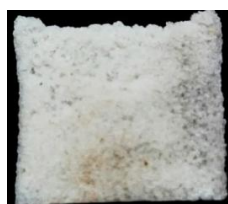
Δοκίμιο Γ: m_{\text{πριν}} = 0.4693\text{g} , m_{\text{μετά}} = 0.4630\text{g}
