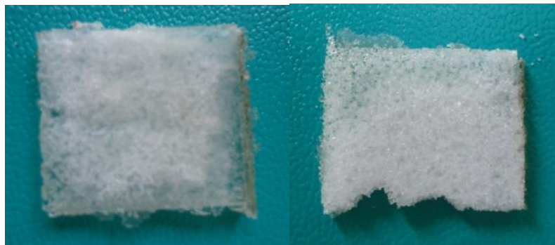
(α) (β) Εικόνα 4. 2: Πλακίδιο PLLA:NaCl (α)40:60 και (β) 30:70 πριν την έκπλυση
