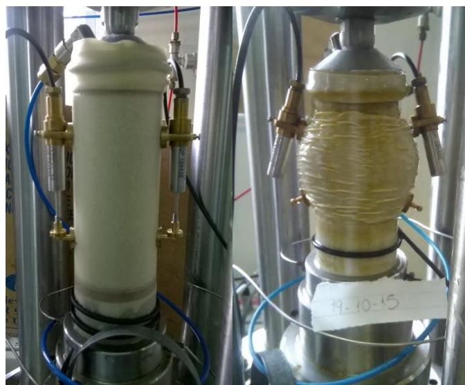
Σχήμα 3.3 Δοκίμιο πριν (αριστερά) και μετά το πέρας της θλίψης (δεξιά)
