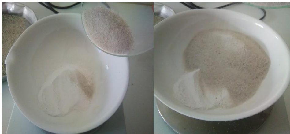
Σχήμα 2.3 Παρασκευή μίγματος άμμου με ποσοστό ιλύος 10%
