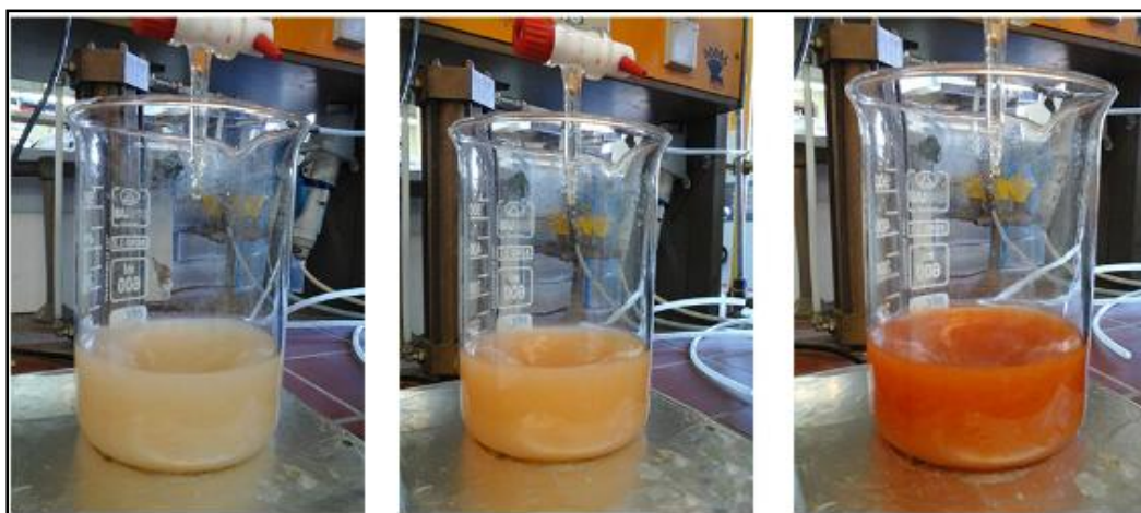
Εικόνα 9 : Χρωματικές αλλαγές του διαλύματος μέχρι να χρωματιστεί ερυθροφαιό, κατά την διάρκεια της τιτλοδότησης σύμφωνα με το πρότυπο ΕΛΟΤ EN 196-2
