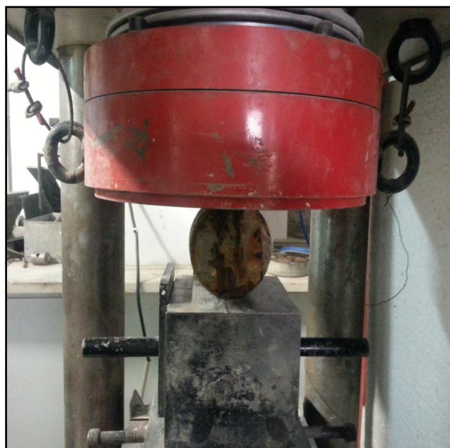
Εικόνα 6: Θραύση του δοκιμίου σε διάρρηξη.
