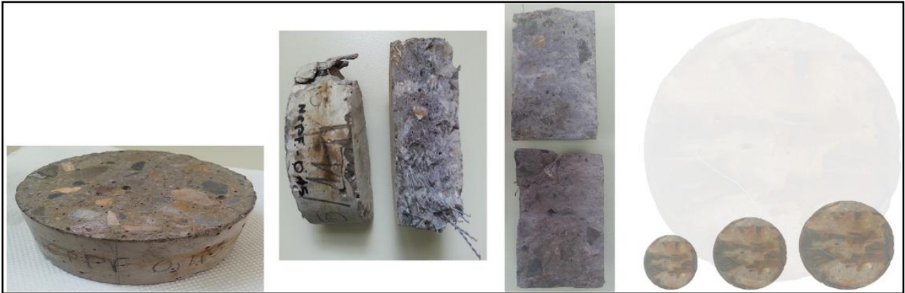
Εικόνα 5: Τυπικό προφίλ δοκιμίου σκυροδέματος κατόπιν δοκιμής αντίστασης σε χλωριόντα, σύμφωνα με το πρότυπο [NordTest Build 492 (1999)] και ψεκάσμού με νιτρικό άργυρο.
