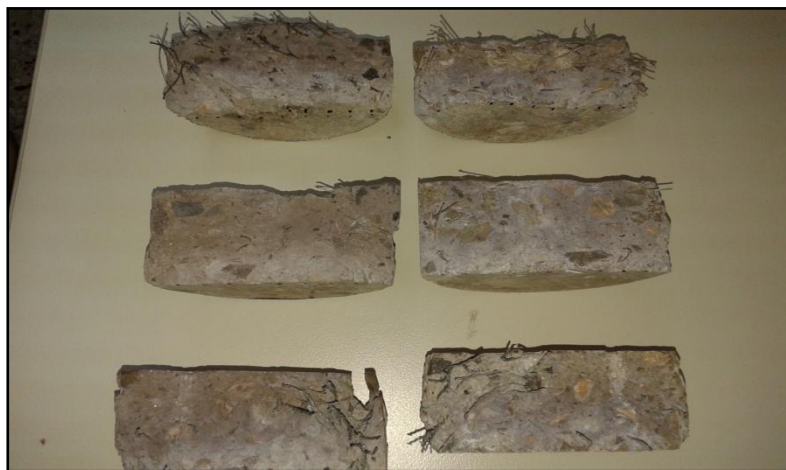
Εικόνα 7: Δοκίμια με χρωματισμένες επιφάνειες για τη μέτρηση του βάθους διείσδυσης χλωριόντων.
