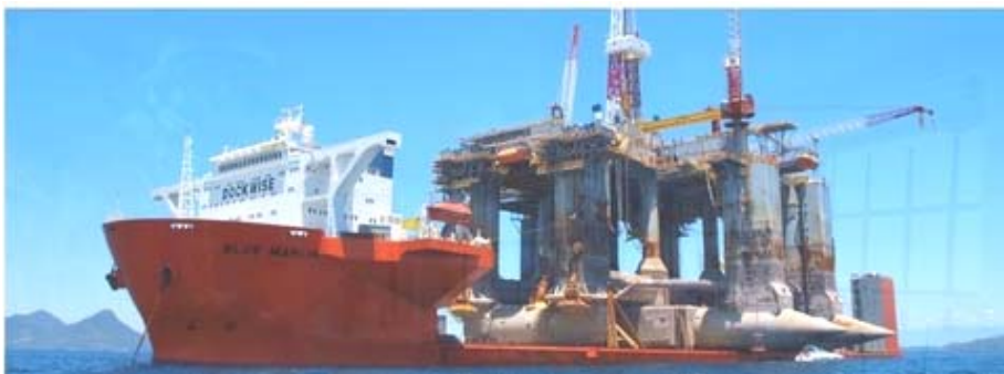
Σχήμα 3.13: Μεταφορά πλωτής ημιβυθισμένης πλατφόρμας [43]
