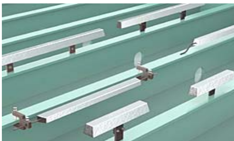
Σχήμα 3.5: Απεικόνιση θυσιαζόμενων ανόδων σε δεξαμενές έρματος (Ballast tanks) [37]
