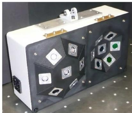
Σχήμα 5. Πλήρες τερματικό σύστημα ενός πομποδέκτη VLC.
