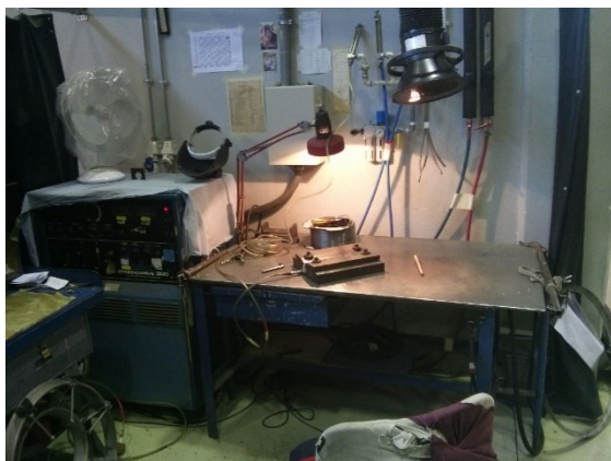
Εικόνα 4-4: Διάταξη συγκόλλησης TIG που χρησιμοποιήθηκε
