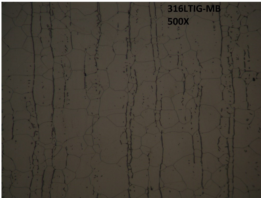
Εικόνα 4-16: Φωτογραφία 500X, μέταλλου βάσης (MB) ανοξείδωτου χάλυβα 316L συγκολλημένου με TIG.
