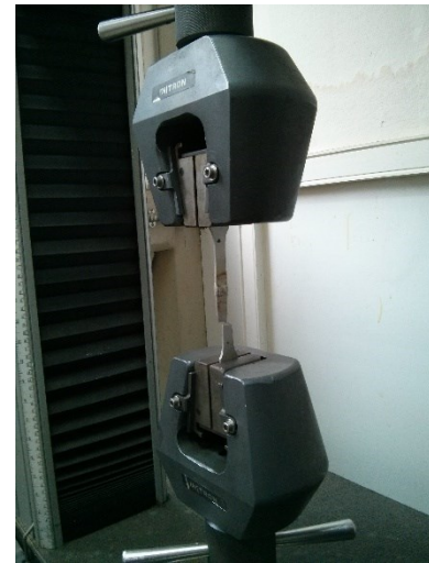
Εικόνα 4-8: Μηχανή εφελκυσμού INSTRON 4482 της σχολής μεταλλειολόγων μηχανικών του ΕΜΠ που χρησιμοποιήθηκε
