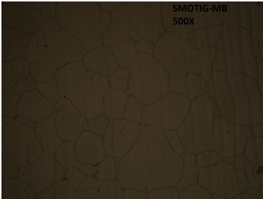
Εικόνα 4-9: : Φωτογραφία 500X, μετάλλου βάσης (MB) ανοξειδωτου χάλυβα SMO 254 συγκολλημένου με TIG
