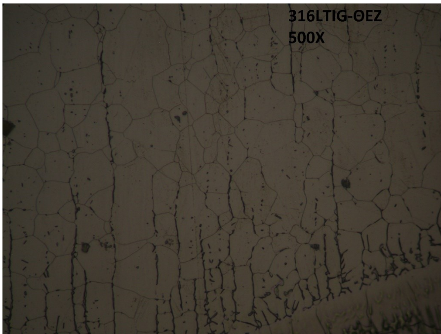
Εικόνα 4-17: Φωτογραφία 500X, θερμικά επηρεασμένης ζώνης (ΘEZ) ανοξείδωτου χάλυβα 316L συγκολλημένου με TIG.
