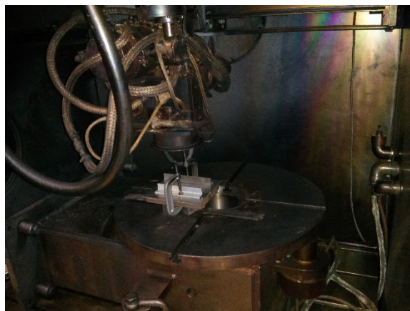
Εικόνα 4-2: Το όπλο ηλεκτρονίων με τα ελάσματα του 316L σε θέση συγκόλλησης
