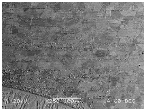
Εικόνα 4-31: Θερμικά Επηρεασμένη Ζώνη (ΘΕΖ) ανοξειδωτου χάλυβα 316L συγκολλημένου με TIG
