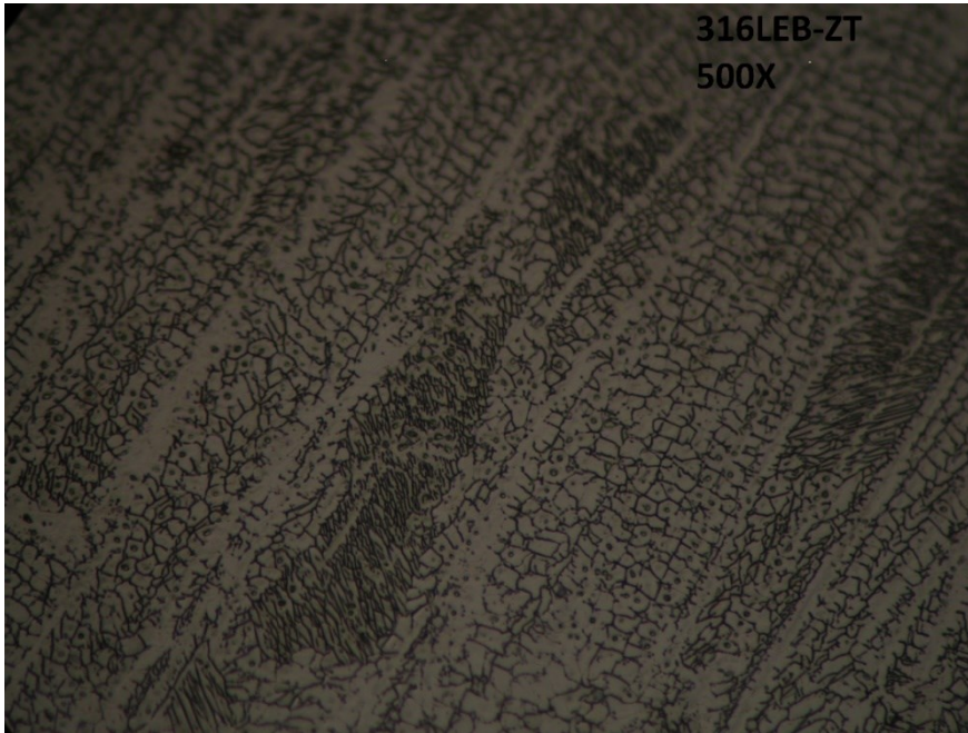
Εικόνα 4-21: Φωτογραφία 500X, ζώνης τηξης (ZT) ανοξείδωτου χάλυβα 316L συγκολλημένου με EBW
