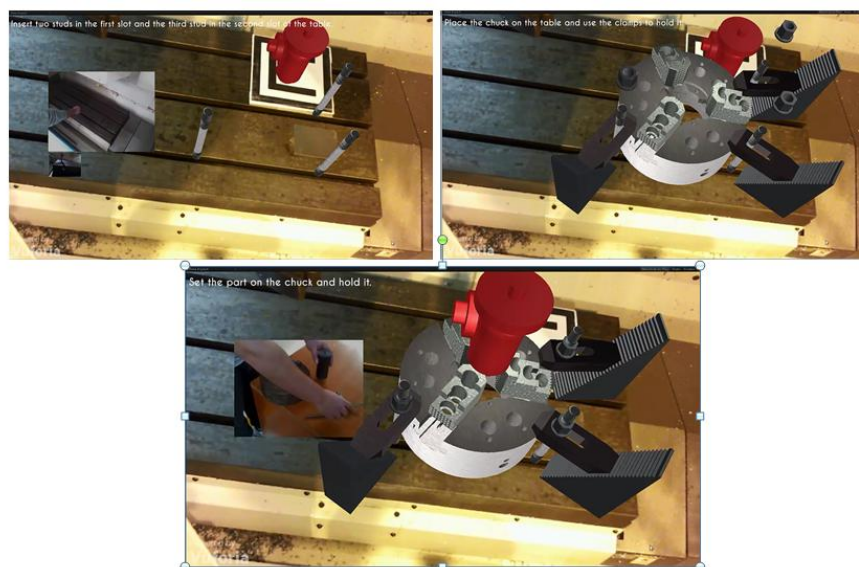
Εικόνα 5.24 – Κατάδειξη στήριξης με χρήση τσωκ
