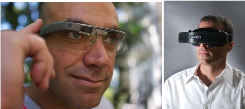
Εικόνα 1.10 – Optical see-through HMD, opaque HMD εικόνες από Wikipedia.org
