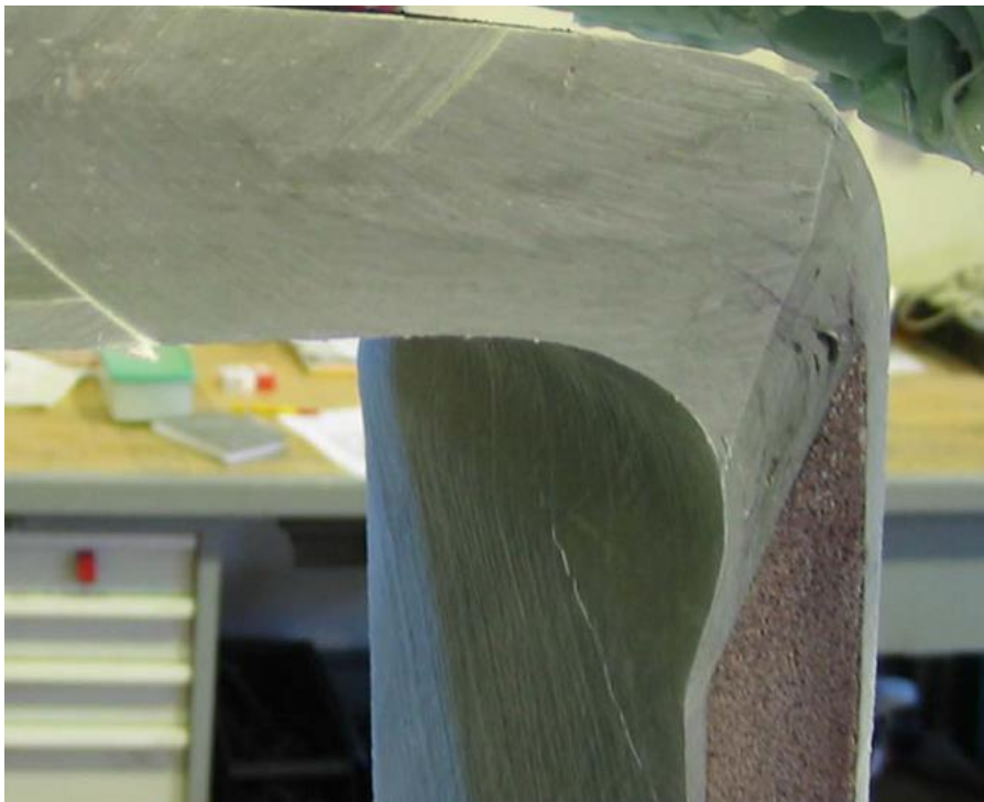
Σχήμα 3.4: Πολυστρωματική και sandwich δομή σε spar-cap και shear-web αντίστοιχα [24]
