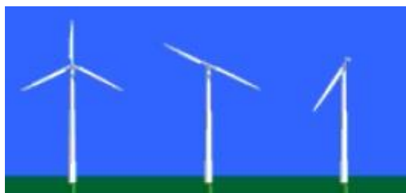
Σχήμα 2.3: Τυπική ανεμογεννήτρια οριζόντιου άξονα, με τρία, δύο και ένα πτερύγια [27]
