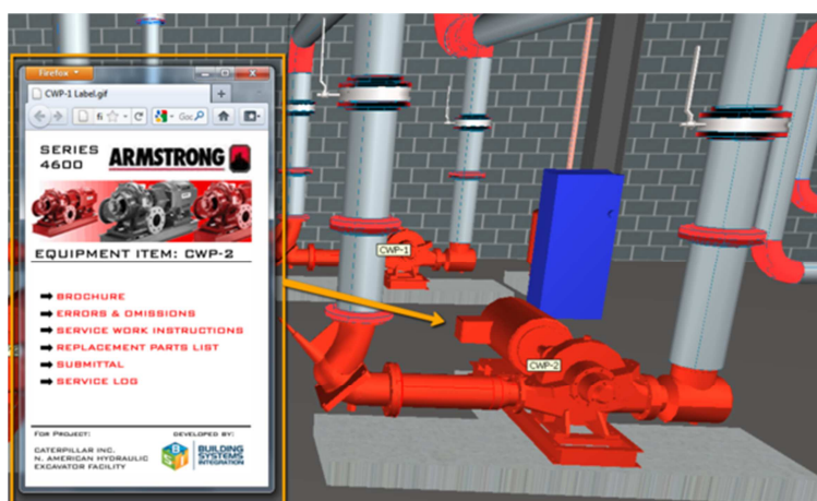
Εικόνα 3-19 : Ενσωμάτωση εγχειριδίων στα αντικείμενα του μοντέλου BIM (Πηγή: www.behance.net )
