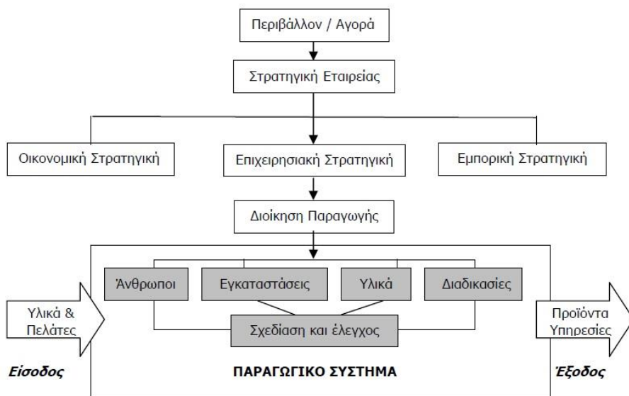
Εικόνα 2.1 Παραγωγικό σύστημα και περιβάλλον αυτού (Production and operations management, Chase, Aquilano & Jacobs)
