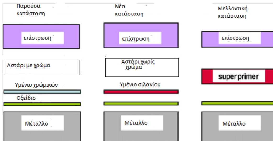
Εικόνα 15: Σχηματική απεικόνιση συστήματος επικάλυψης με super-primer (υπέρ ασάρι) [207].
