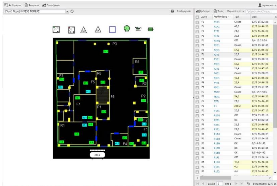
Σχήμα 7.9: Παρακολούθηση των θαλάμων και των αισθητήρων σε πραγματικό χρόνο στο e-Meter
