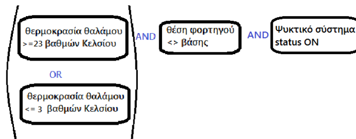
Σχήμα 6.16: Η λογική του κανόνα της θερμοκρασίας δωματίου των φορτηγών στο e-Track
