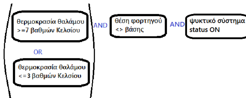
Σχήμα 6.14: Η λογική του κανόνα της θερμοκρασίας ψυγείου των φορτηγών στο e-Track
