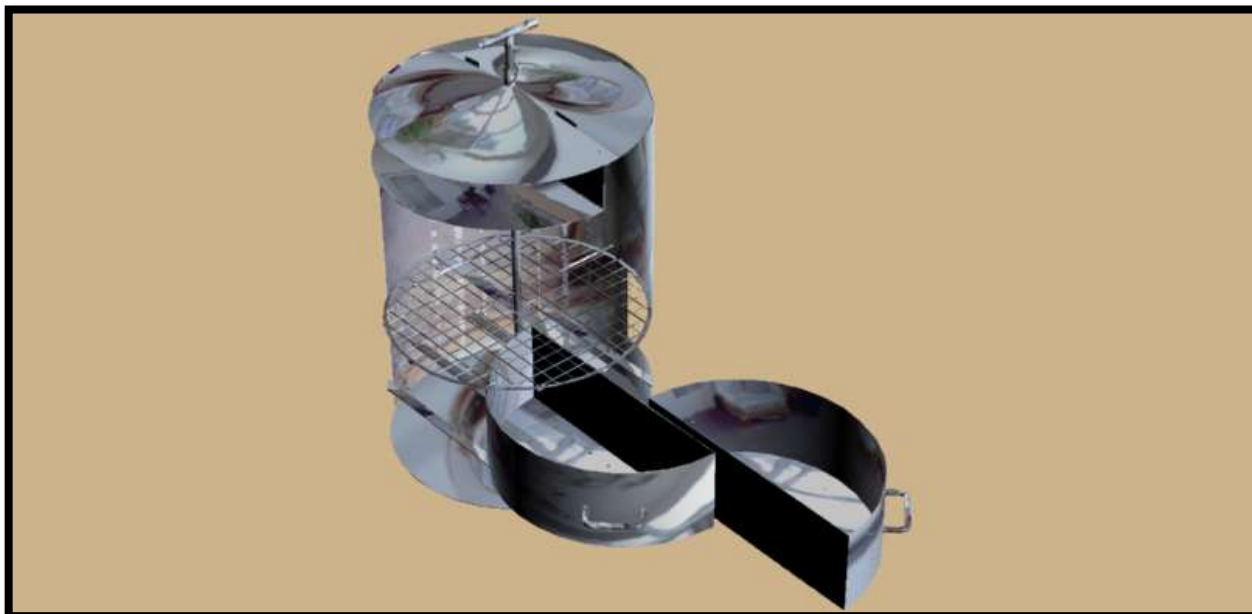
Εικόνα 17: Εσωτερικό οικιακού κομποστοποιητή (υποδοχείς εκτός του συστήματος)
