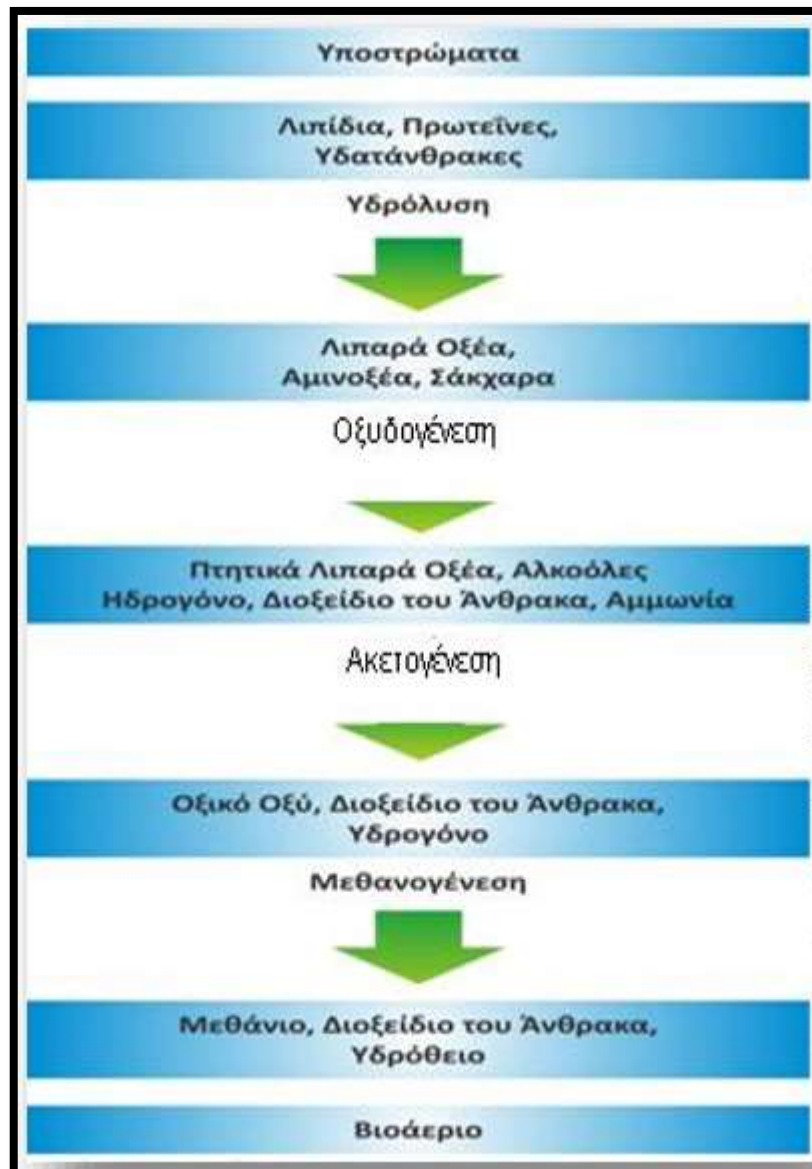
Εικόνα 12: Διεργασία Αναερόβιας Χώνευσης (University of Iowa, 2012)
