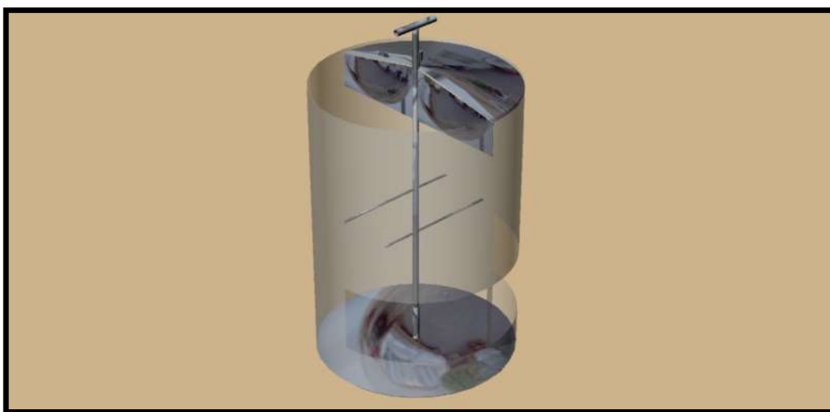
Εικόνα 14: Θέση του αναδευτήρα στο εσωτερικό του θαλάμου (Μαργαρίτης, 2013)
