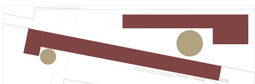
ΣΧΗΜΑ "Γ" ΟΣΤΕ ΝΑ ΣΧΗΜΑΤΙΖΕΤΑΙ ΜΙΑ ΚΕΝΤΡΙΚΗ ΕΣΩΤΕΡΙΚΗ ΠΛΑΤΕΙΑ ΚΑΙ ΝΑ ΑΠΟΦΕΥΧΘΕΙ Ο ΚΑΤΑΚΕΡΜΑΤΙΣΜΟΣ ΤΟΥ ΥΠΑΙΘΡΙΟΥ ΧΩΡΟΥ.
