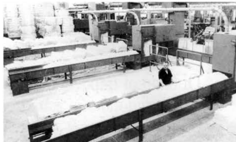
μηχανές ανοίγματος, καθαρισμού, και ανάμειξης της πρώτης ύλης
