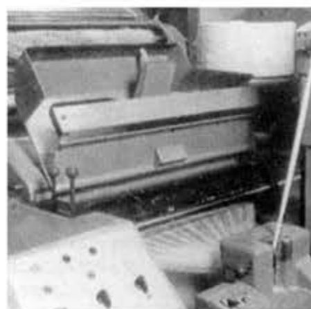
μηχανή διαμόρφωσης του φυτίλιού (χάρτζια)
