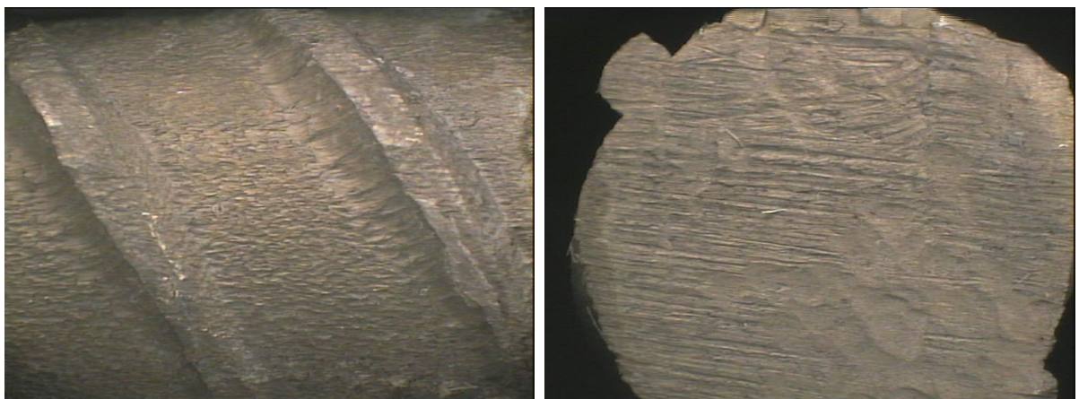
Φωτογραφία 8.16. Μεγέθυνση X25 παράπλευρου τμήματος και διατομής χάλυβα οπλισμού σκυροδέματος από δοκίμιο κισσηροκονιάματος με αναστολέα διάβρωσης FI. Δεξιά φαίνεται ανέπαφο τμήμα οπλισμού, ενώ αριστερά φαίνονται οι γραμμές που προκάλεσε ο κοπτικός τροχός στη διατομή του χάλυβα.
