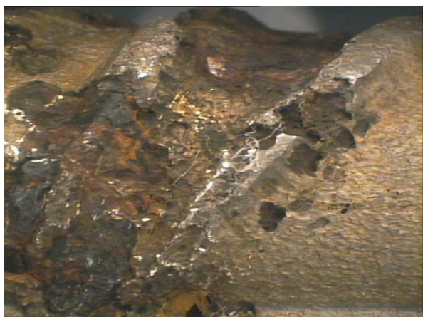
Φωτογραφία 8.11. α, β. Μεγέθυνση X25 χάλυβα οπλισμού σκυροδέματος, μετά τον καθαρισμό του από τα προϊόντα διάβρωσης, από δοκίμιο κισσηροκονιάματος με αναστολέα διάβρωσης DO. Διακρίνεται έντονη διάβρωση με βελονισμούς στην ανάγλυφη νεύρωση (αριστερά).
