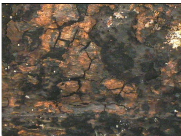
Φωτογραφία 8.9. α, β. Μεγέθυνση X25 χάλυβα οπλισμού σκυροδέματος, πριν τον καθαρισμό του από τα προϊόντα διάβρωσης, από δοκίμιο κισσηροκονιάματος με αναστολέα διάβρωσης MO. Είναι εμφανή τα σαθρά και ρηγματωμένα προϊόντα διάβρωσης πάνω στον οπλισμό. Η μεγαλύτερη μεγέθυνση X50 (δεξιά) εμφανίζει πιο καθαρά την κατάσταση των προϊόντων διάβρωσης.
