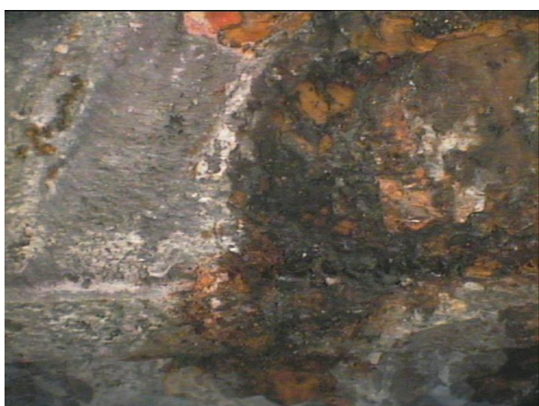
Φωτογραφία 8.10. α, β. Μεγέθυνση X25 χάλυβα οπλισμού σκυροδέματος, πριν τον καθαρισμό του από τα προϊόντα διάβρωσης, από δοκίμιο κισσηροκονιάματος με αναστολέα διάβρωσης DI.
