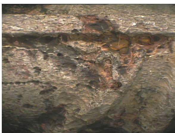
Φωτογραφία 8.13. α, β. Μεγέθυνση X25 χάλυβα οπλισμού σκυροδέματος, μετά τον καθαρισμό του από τα προϊόντα διάβρωσης, από δοκίμιο κισσηροκονιάματος με αναστολέα διάβρωσης FO. Διακρίνεται έντονη τοπική διάβρωση.
