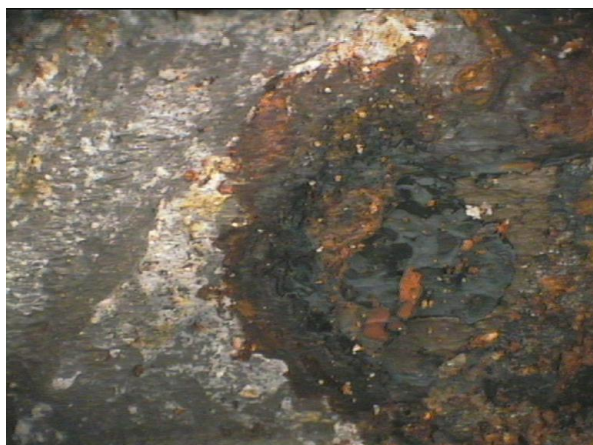
Φωτογραφία 8.8. α, β. Μεγέθυνση X25 χάλυβα οπλισμού σκυροδέματος, πριν τον καθαρισμό του από τα προϊόντα διάβρωσης, από δοκίμιο κισσηροκονιάματος με αναστολέα διάβρωσης DO (αριστερά) και FO (δεξιά). Είναι εμφανή τα προϊόντα διάβρωσης πάνω στον οπλισμό. Διακρίνονται κόκκινα οξειδία του σιδήρου ( Fe_2O_3 ) και τοπικός σχηματισμός μαύρου οξειδίου του σιδήρου ( Fe_3O_4 ).
