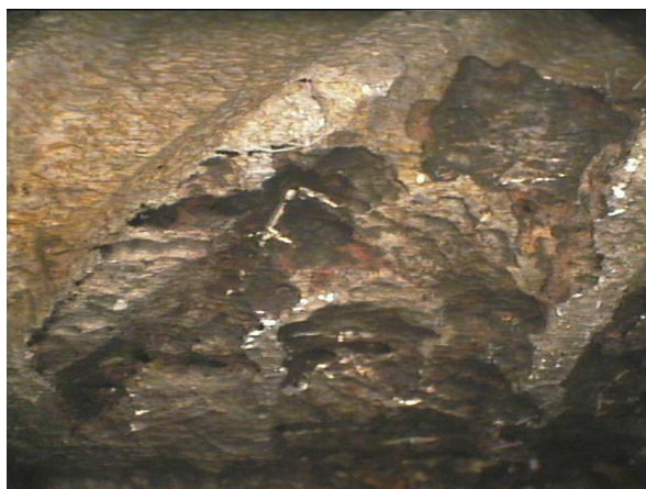
Φωτογραφία 8.11. α, β. Μεγέθυνση X25 χάλυβα οπλισμού σκυροδέματος, μετά τον καθαρισμό του από τα προϊόντα διάβρωσης, από δοκίμιο κισσηροκονιάματος με αναστολέα διάβρωσης DO. Διακρίνεται έντονη διάβρωση με βελονισμούς στην ανάγλυφη νεύρωση (αριστερά).
