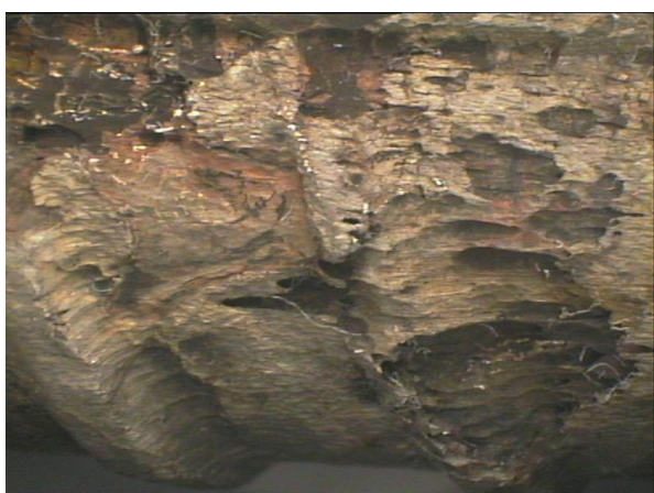
Φωτογραφία 8.12. α, β. Μεγέθυνση X25 χάλυβα οπλισμού σκυροδέματος, μετά τον καθαρισμό του από τα προϊόντα διάβρωσης, από δοκίμιο κισσηροκονιάματος με αναστολέα διάβρωσης MO. Διακρίνεται έντονη τοπική διάβρωση.
