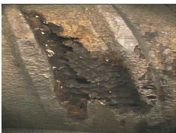
Φωτογραφία 8.13. α, β. Μεγέθυνση X25 χάλυβα οπλισμού σκυροδέματος, μετά τον καθαρισμό του από τα προϊόντα διάβρωσης, από δοκίμιο κισσηροκονιάματος με αναστολέα διάβρωσης FO. Διακρίνεται έντονη τοπική διάβρωση.
