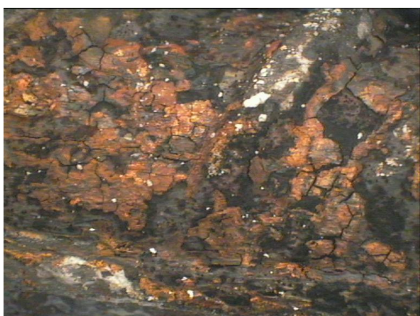
Φωτογραφία 8.9. α, β. Μεγέθυνση X25 χάλυβα οπλισμού σκυροδέματος, πριν τον καθαρισμό του από τα προϊόντα διάβρωσης, από δοκίμιο κισσηροκονιάματος με αναστολέα διάβρωσης MO. Είναι εμφανή τα σαθρά και ρηγματωμένα προϊόντα διάβρωσης πάνω στον οπλισμό. Η μεγαλύτερη μεγέθυνση X50 (δεξιά) εμφανίζει πιο καθαρά την κατάσταση των προϊόντων διάβρωσης.
