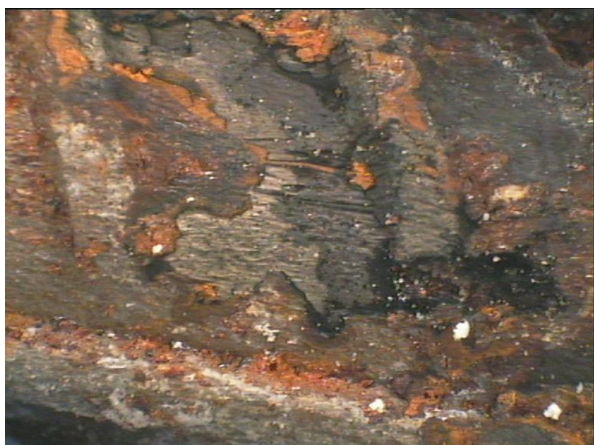
Φωτογραφία 8.8. α, β. Μεγέθυνση X25 χάλυβα οπλισμού σκυροδέματος, πριν τον καθαρισμό του από τα προϊόντα διάβρωσης, από δοκίμιο κισσηροκονιάματος με αναστολέα διάβρωσης DO (αριστερά) και FO (δεξιά). Είναι εμφανή τα προϊόντα διάβρωσης πάνω στον οπλισμό. Διακρίνονται κόκκινα οξειδία του σιδήρου ( Fe_2O_3 ) και τοπικός σχηματισμός μαύρου οξειδίου του σιδήρου ( Fe_3O_4 ).
