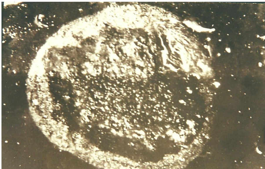
Σχήμα 6.5. Τομή κόκκου σκουριάς στο ηλεκτρονικό μικροσκόπιο.
