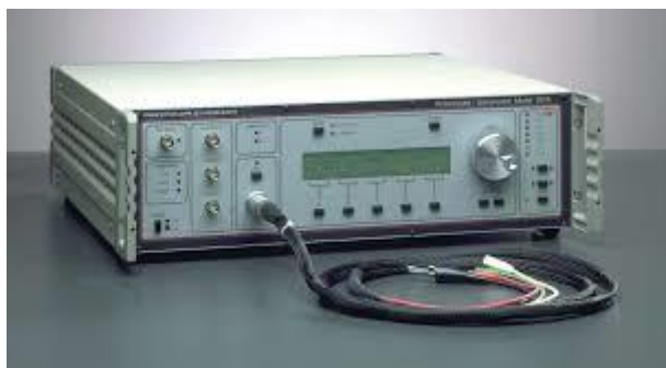
Εικόνα 7.1. Ποτενσιοστάτης γραμμικής πόλωσης 263A EG&G.
