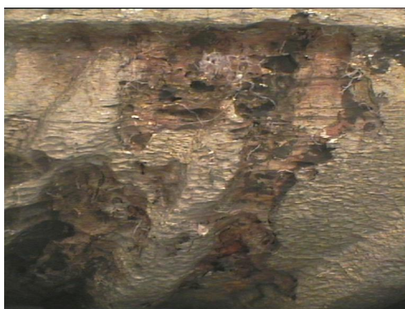
Φωτογραφία 8.12. α, β. Μεγέθυνση X25 χάλυβα οπλισμού σκυροδέματος, μετά τον καθαρισμό του από τα προϊόντα διάβρωσης, από δοκίμιο κισσηροκονιάματος με αναστολέα διάβρωσης MO. Διακρίνεται έντονη τοπική διάβρωση.
