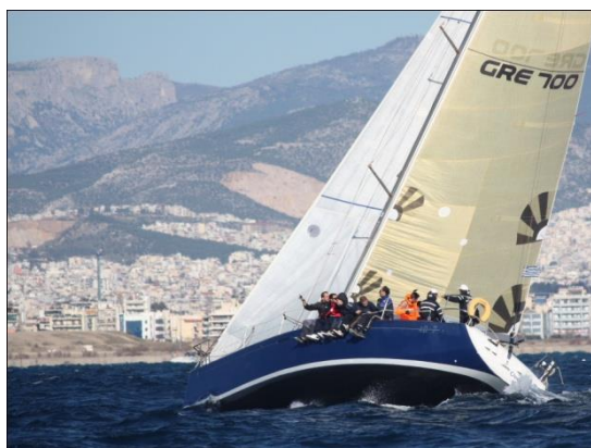
Σχήμα 3.13 Ιστιοπλοϊκό σκάφος με πανί από ινώδες σύνθετο υλικό
