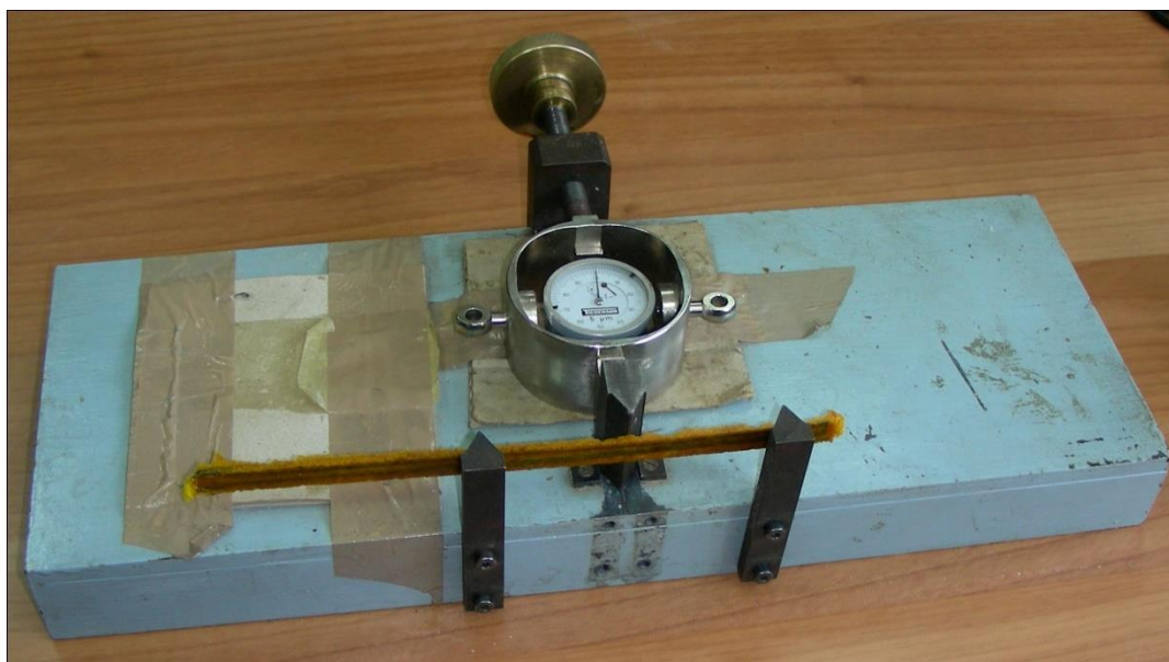
Σχήμα 7.2 Διάταξη μέτρησης δοκιμής σε κάμψη και διάτμηση
