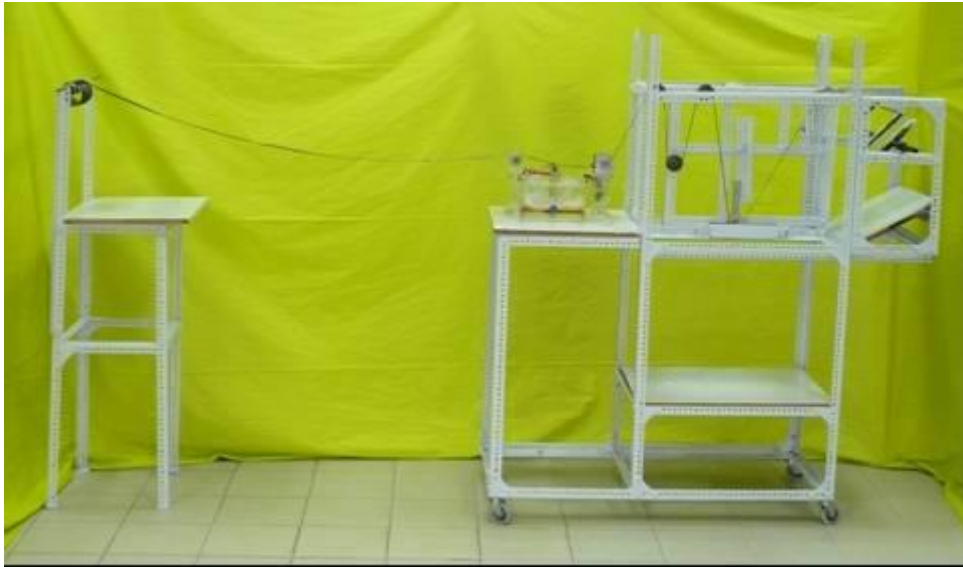
Σχήμα 6.2 Εργαστηριακή διάταξη που χρησιμοποιήθηκε για προδιαπότιση των ινών
