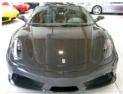
Σχήμα 3.12 Αυτοκίνητο κατασκευασμένο από ίνες άνθρακα
