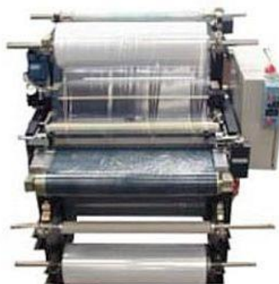
Σχήμα 6.1 Μηχάνημα παραγωγής pre-preg ινών
