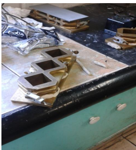
Εικόνα 9. Καλούπια για μέτρηση αντοχών κατά ASTM C109/C109M
