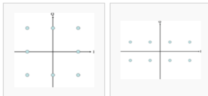
Εικόνα 3-5– Διαγράμματα αστερισμού για διαφορετικά 8-QAM
