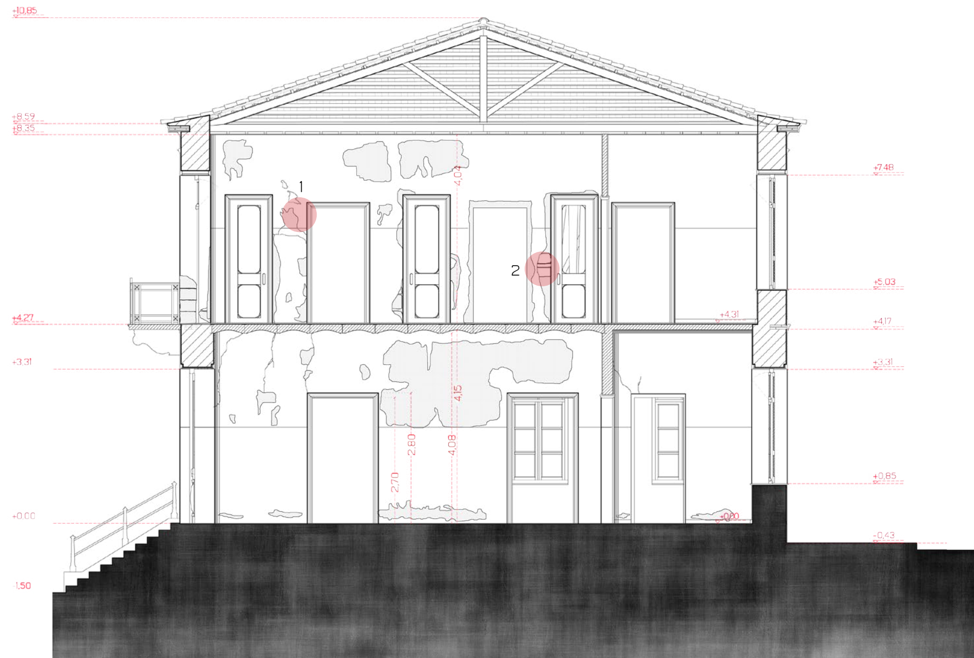
2. βλάβες λιθοδομής - κουφωμάτων
