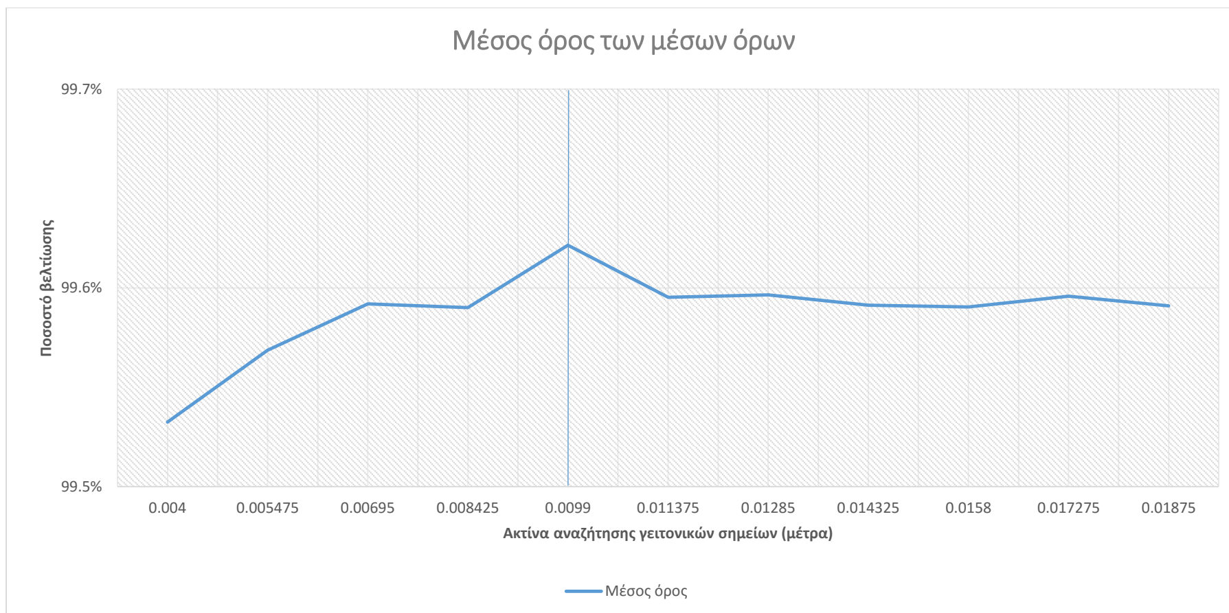
Σχήμα 32 : Γραφική παράσταση μέσου όρου των μέσων όρων ποσοστού βελτίωσης για όλα τα υπό εξέταση τρισδιάστατα σημειακά νέφη ως προς την ακτίνα αναζήτησης γειτονικών σημείων με άνω όριο τους 1050 γείτονες
