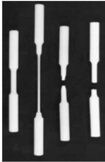
Εικόνα 3.14: Πολυμερικά δοκίμια εφελκυσμού: πριν τη δοκιμή (αριστερά) και μετά τη δοκιμή (δεξιά κατά σειρά - HDPE, Nylon, PTFE)
