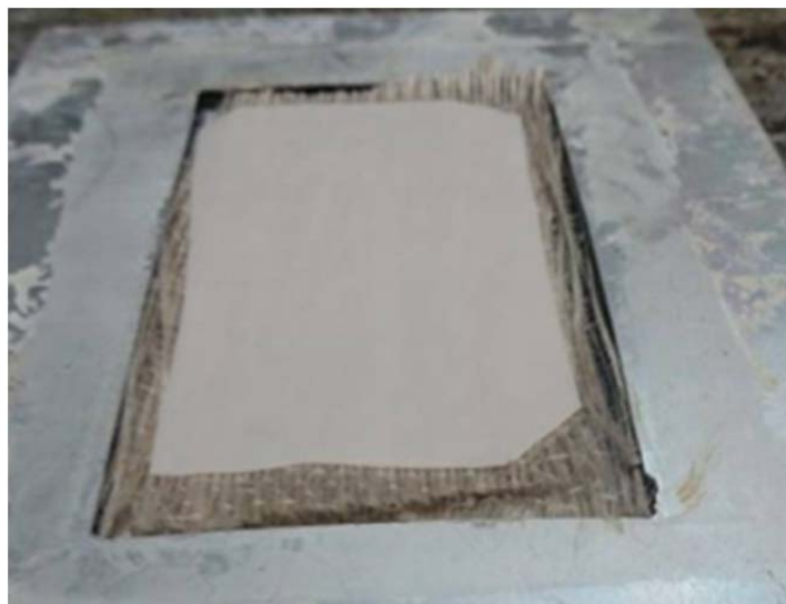
Εικόνα 3.3: Η τεχνική «Film stacking method»
