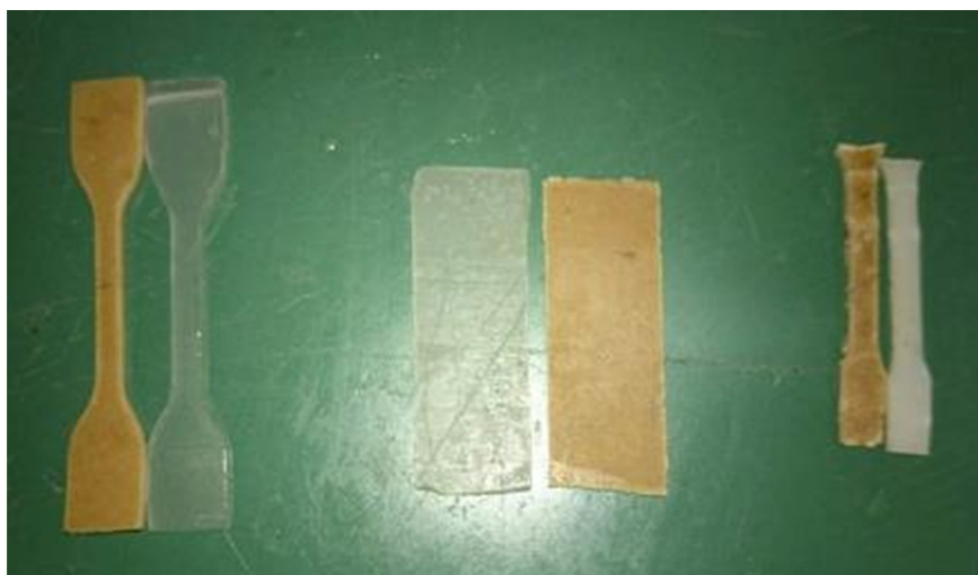
Εικόνα 3.7: Δοκίμια εφελκυσμού (αριστερά), κάμψης στο κέντρο και εφελκυσμού στο DMA (δεξιά)
