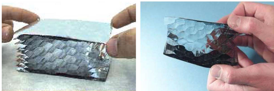
Εικόνα 16: Δομή ενός GFP [Jelle, 2011]
