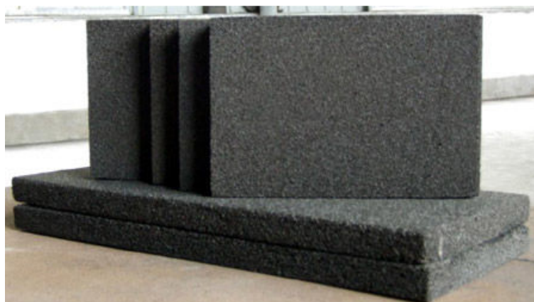
Εικόνα 9: Πλάκες αφρώδους γυαλιού
