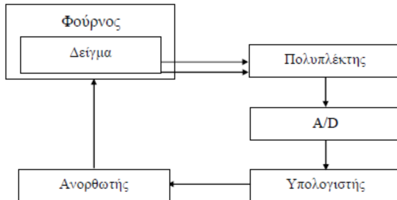
Εικόνα 21: Σχηματικό διάγραμμα των επιμέρους συσκευών μιας πειραματικής διάταξης της μεθόδου μεταβολής της ακτινικής ροής θερμότητας
