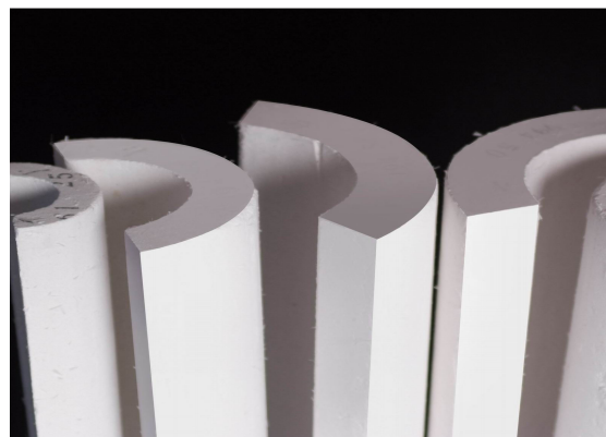
Εικόνα 12: Πλάκες και κοχύλια περλίτη για εφαρμογές θερμομόνωσης
