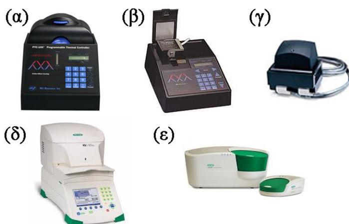
Εικόνα 2 – Συμβατικές διατάξεις θερμοκυκλοποιητών (thermal cyclers)
