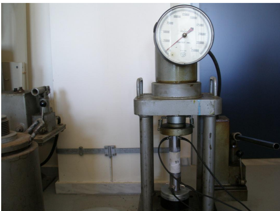
Σχήμα 4.7: Συσκευή φόρτισης και πιεζοηλεκτρικοί μετατροπείς.
