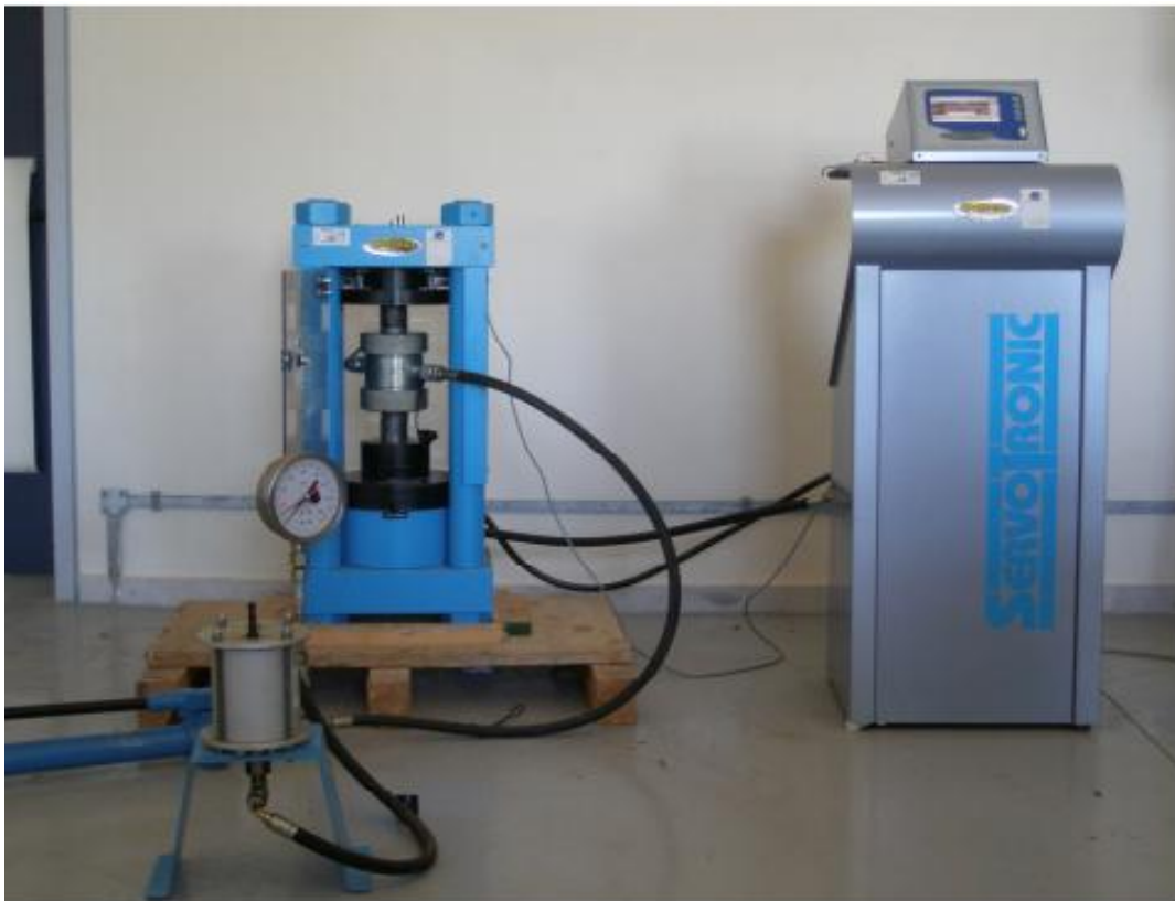
Σχήμα 4.19: Τοποθέτηση κυψέλης Hoek στη συσκευή επιβολής αξονικού φορτίου.
