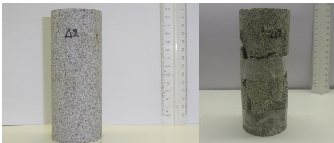
Σχήμα 5.8: Φωτογραφία δοκιμίου Δ2 πριν και μετά τη θραύση.
