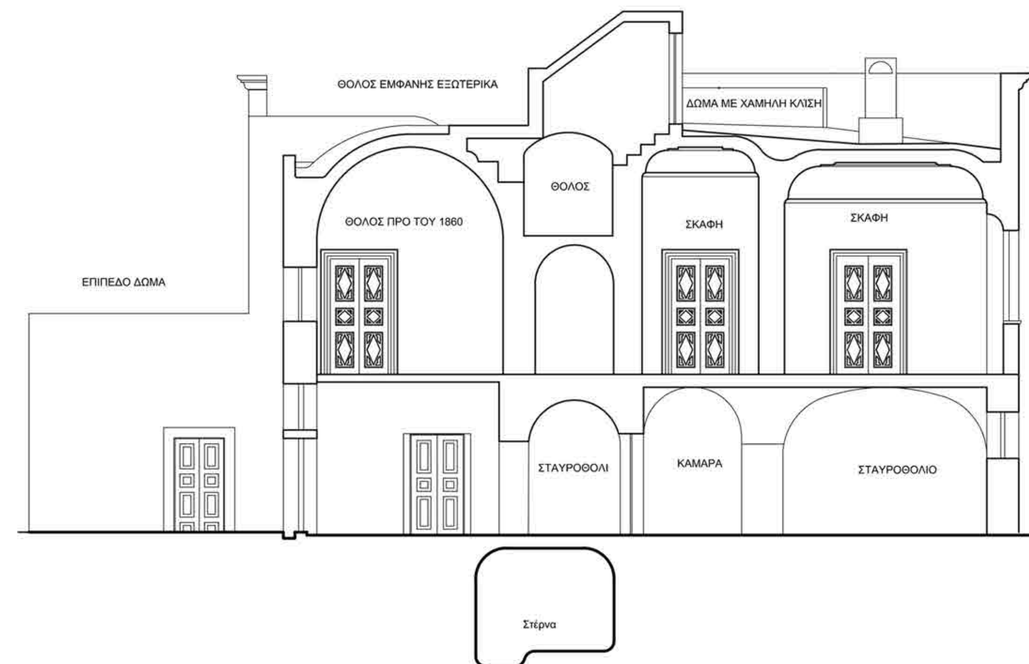
Υπαρξη διαφορετικών συστημάτων στέγασης στο προς αποκατασταση κτήριο
