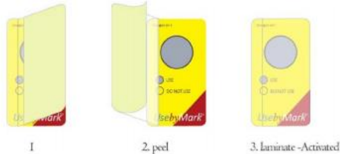
Εικόνα 3.14: Διαδικασία ενεργοποίησης του δείκτη CoolVu
