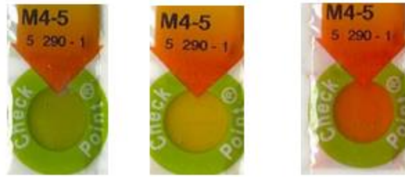
Εικόνα 3.19: Tricolor ΤΠΙ. VITSAB (πράσινο→κίτρινο→κόκκινο)
