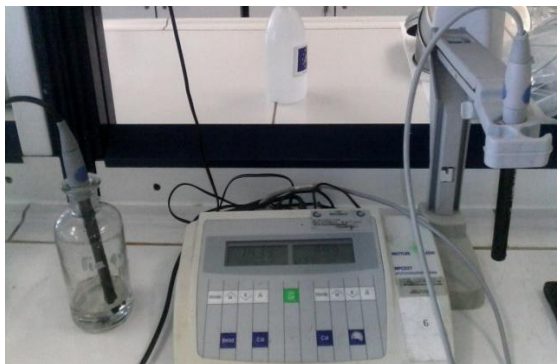
Εικόνα 15: Μέτρηση pH και αγωγιμότητας
