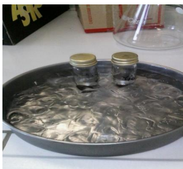
Εικόνα 28: Τοποθέτηση δείγματος σε παγόλουτρο για 20min
