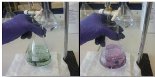
Εικόνα 39: Μετά την απόσταξη και πριν την τιτλοδότηση (αριστερά) και μετά την τιτλοδότηση (δεξιά)
