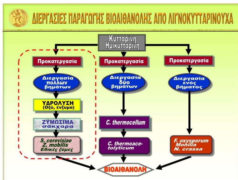
Εικόνα 9: Σχηματική απεικόνιση διεργασιών παραγωγής βιοαιθανόλης από λιγνοκυτταρινούχα [30],[31]
