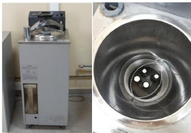
Εικόνα 33: Συσκευή αποστείρωσης (αριστερά) και κωνικές φιάλες στο εσωτερικό της για αποστείρωση στους 121°C (δεξιά)
