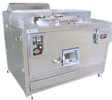
Εικόνα 10: Το εμπορικό σύστημα ξήρανσης βιομάζας δυνατότητας επεξεργασίας 100 Kgr υλικού/ημέρα
