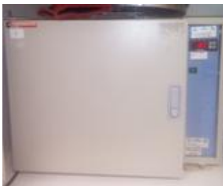
Εικόνα 11: Φούρνος ξήρανσης με αέρα στους 80°C
