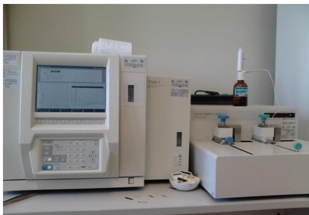
Εικόνα 16: Συσκευή μέτρησης TOC
