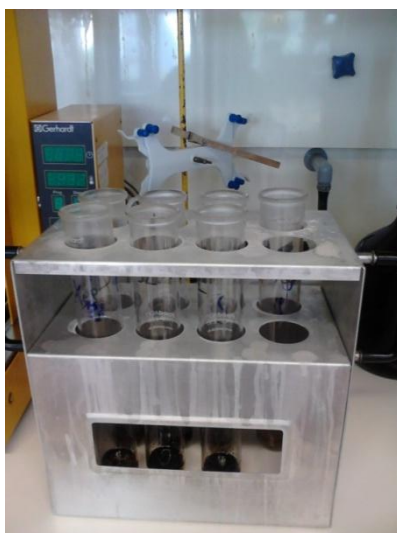
Εικόνα 35: Διάλυμα ξηρού υλικού και θειικού οξέος σε ηρεμία
