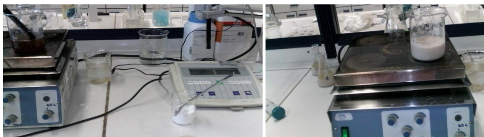
Εικόνα 34: Αρχή της εξουδετέρωσης του δείγματος με \text{CaCO}_3 (αριστερά) και εξουδετερωμένο δείγμα σε \text{pH}=5-5,5 (δεξιά)
