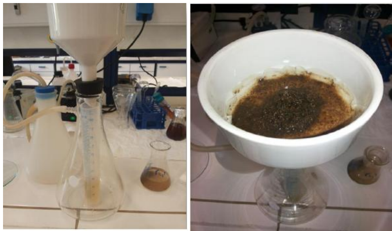
Εικόνα 23: Συλλογή υγρού στον ογκομετρικό κύλινδρο (αριστερά) και συγκράτηση στερεού εκχυλίσματος στο διηθητικό χαρτί (δεξιά)
