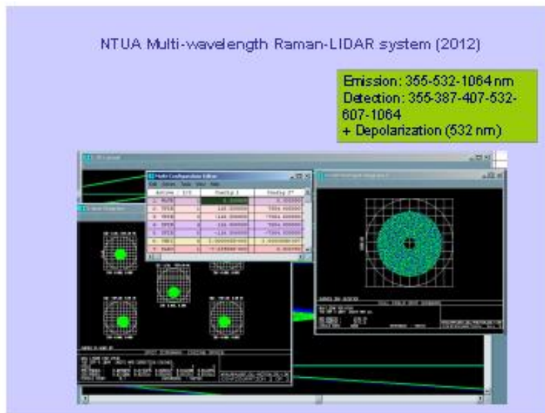
Σχήμα 4.10: Απεικόνιση σημάτων LIDAR της διάταξης Raman-LIDAR του ΕΜΠ μέσω λογισμικού οπτικής σχεδίασης [12].
