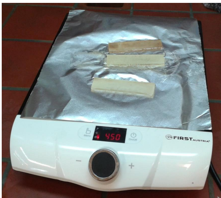
Σχήμα 32. Θέρμανση των υμενίων τιτανίας ντοπαρισμένα με ουρία στην αυτοσχέδια θερμή πλάκα.
