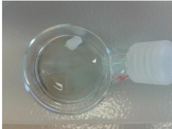
Σχήμα 62. Πλήρης αποχρωματισμός και αποικοδόμηση του MB μετά από ακτινοβολήση μίας ημέρας.
