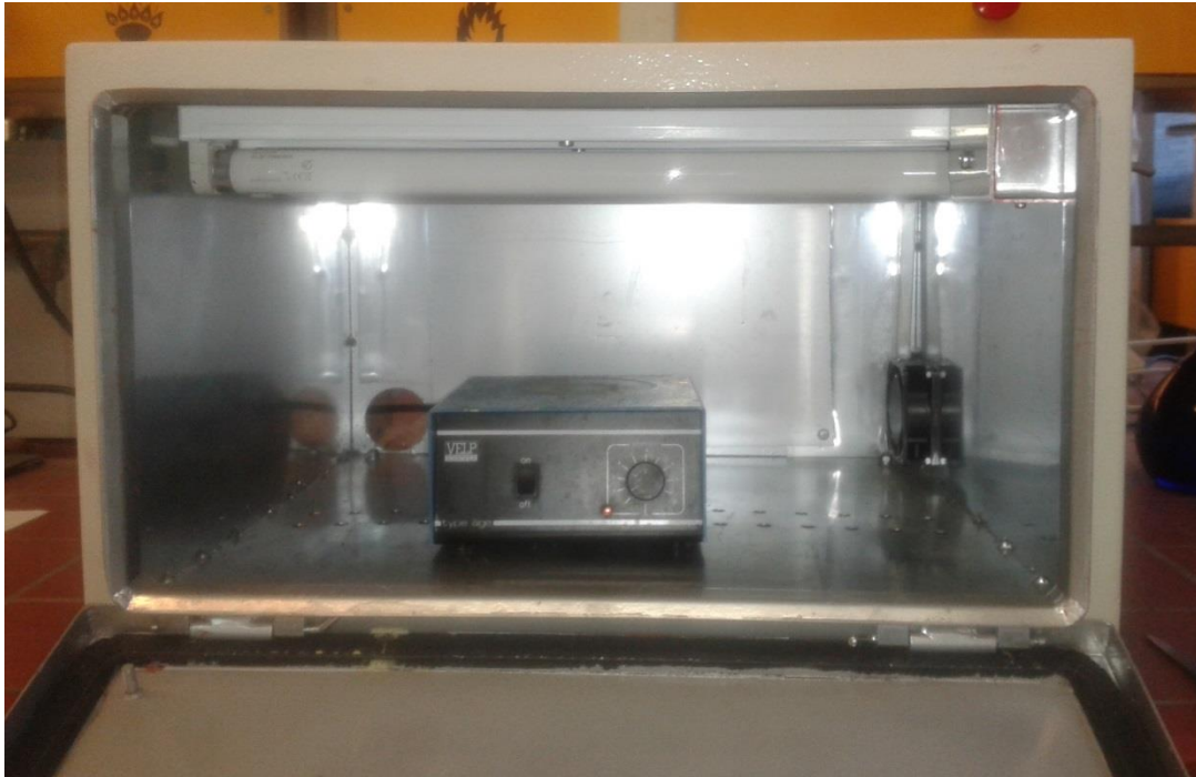
Σχήμα 46. Ειδικός χώρος για φωτοκατάλυση.
