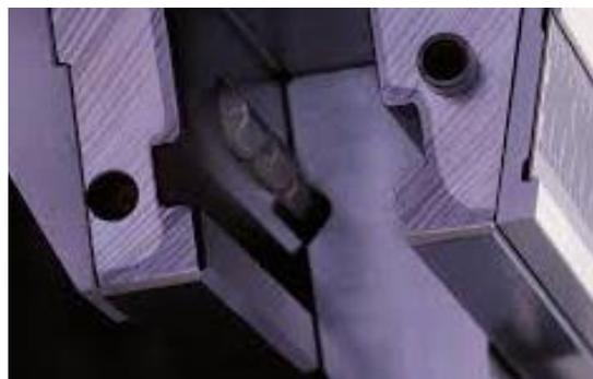
Εικόνα 44 Μηχανισμός σύσφιξης συστήματος "New Standard Premium Clamping"
