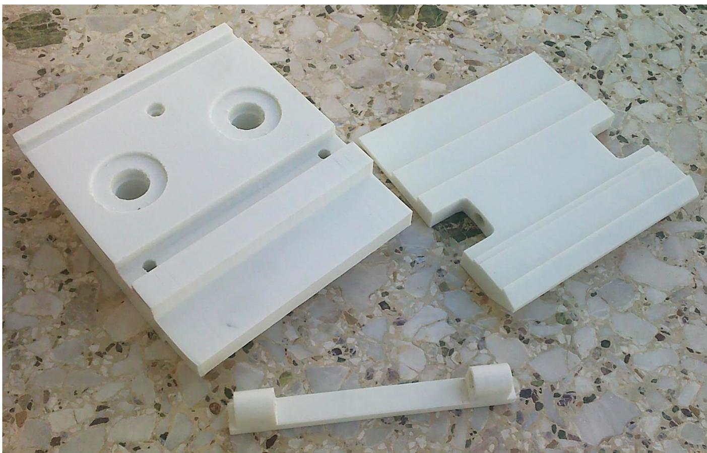
Εικόνα 101 Βασικά μέρη συστήματος συγκράτησης όπως τυπώθηκαν σε 3D Printer
