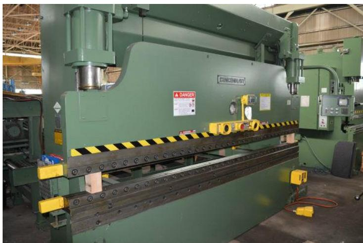
Εικόνα 22 Παράδειγμα τυπικής στραντζόπρεσας
