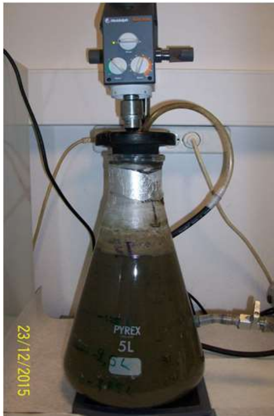
Εικόνα 3.1 Σύστημα αναερόβιας υδρόλυσης ιλύος
