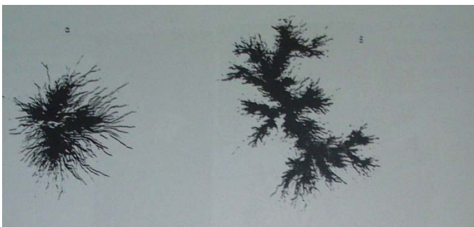
Εικόνα 4.7.2-3: Φωτογραφίες δενδριτών κατά την καταπόνηση πολυμερών στερεών μονωτικών στον αέρα
