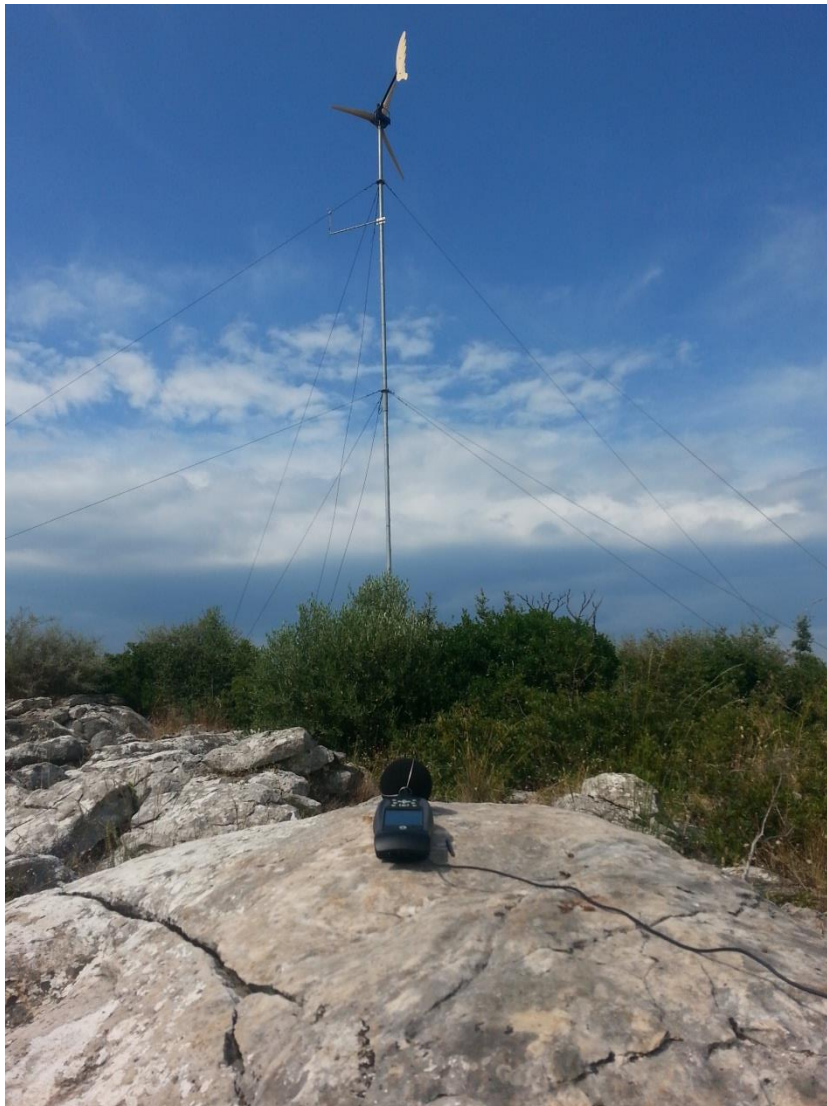
Εικόνα 5.5 : Τοποθέτηση ηχομέτρου σε βράχο
