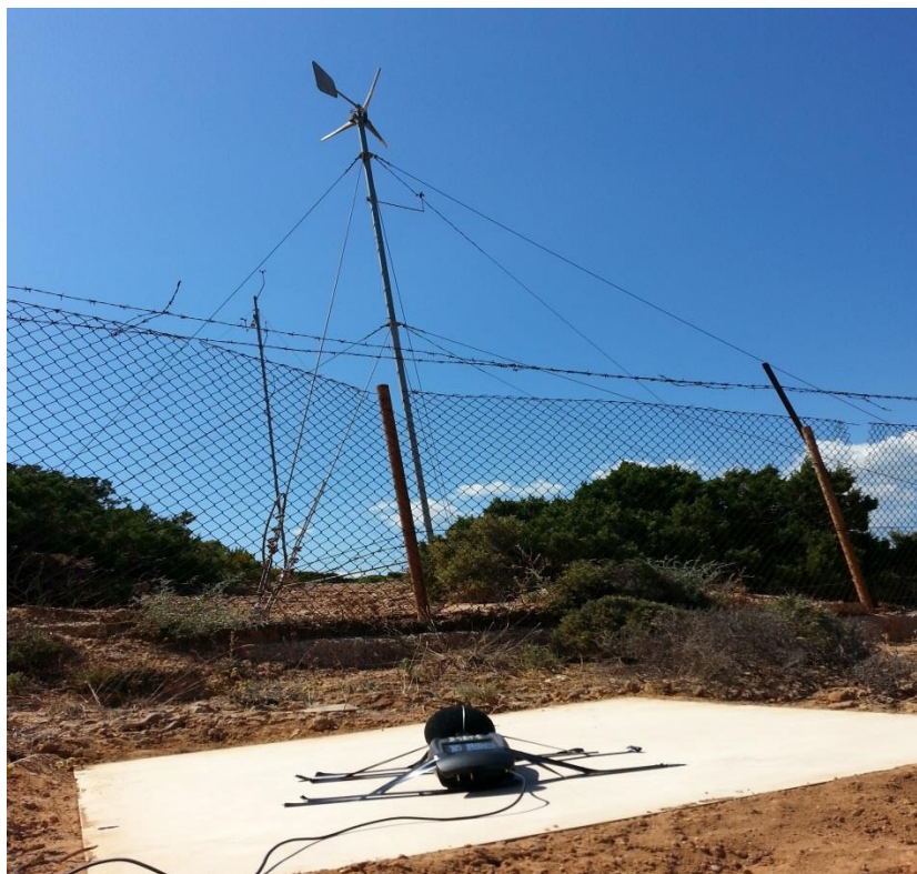
Εικόνα 5.2 : Τοποθέτηση ηχομέτρου στην πλατφόρμα μετρήσεων
