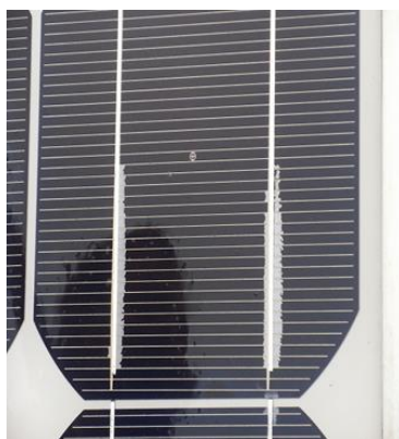
Εικόνα 3.9 : Αποκόλληση της επικάλυψης.
