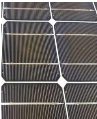
Εικόνα 3.8 : Αλλοίωση στο χρώμα της επικάλυψης EVA.
