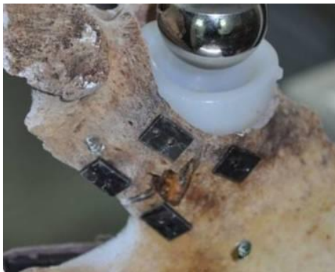
Εικόνα 5.13: Η τοποθέτηση του τεχνητού χόνδρου μέσα στην κοτύλη.
