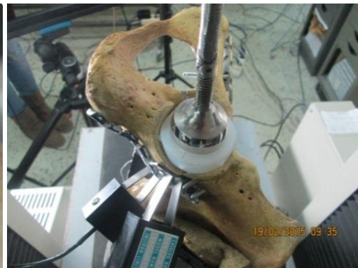
Εικόνα 5.14: Η τοποθέτηση της κεφαλής του προσομοιώματος του μηριαίου οστού στον χόνδρο και η στήριξη των clip gauges.
