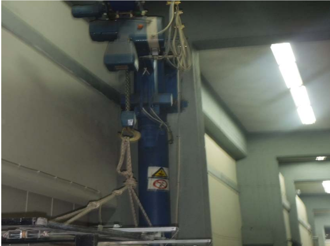
Εικόνα 3.5: Ανύψωση οργάνων με χρήση ακατάλληλων σχοινιών
