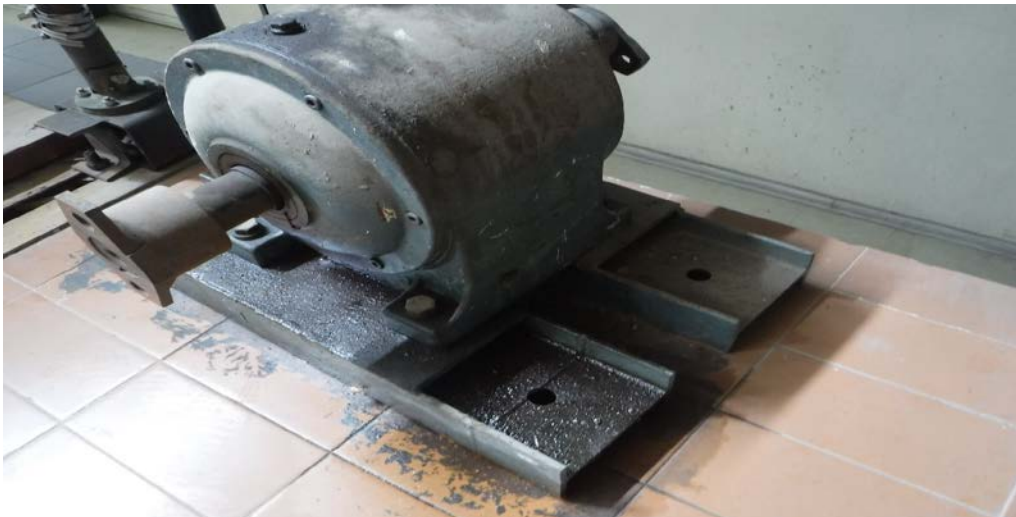
Εικόνα 4.21: Ρινίσματα και σκουριά είναι εμφανείς στο μοτέρ
