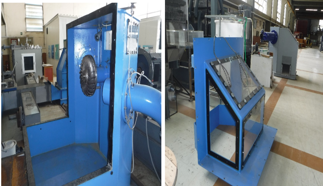
Εικόνα 4.18 :Αντλία χωρίς τον ειδικό προφυλακτήρα
