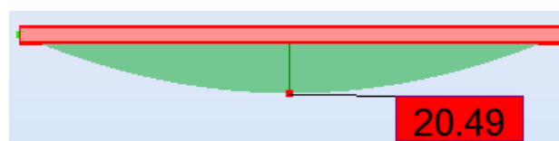
Σχήμα 4.18: Διάγραμμα ροπών τεγίδας για τον συνδυασμό SLS 1.
