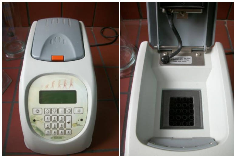
Εικόνα 4.16. Θερμικός κυκλοποιητής (PCR) και θέσεις φόρτωσης δειγμάτων (δεξιά).
