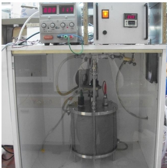
Εικόνα 3.2. Εργαστηριακός αναερόβιος βιοαντιδραστήρας αναγωγής Cr[VI]
