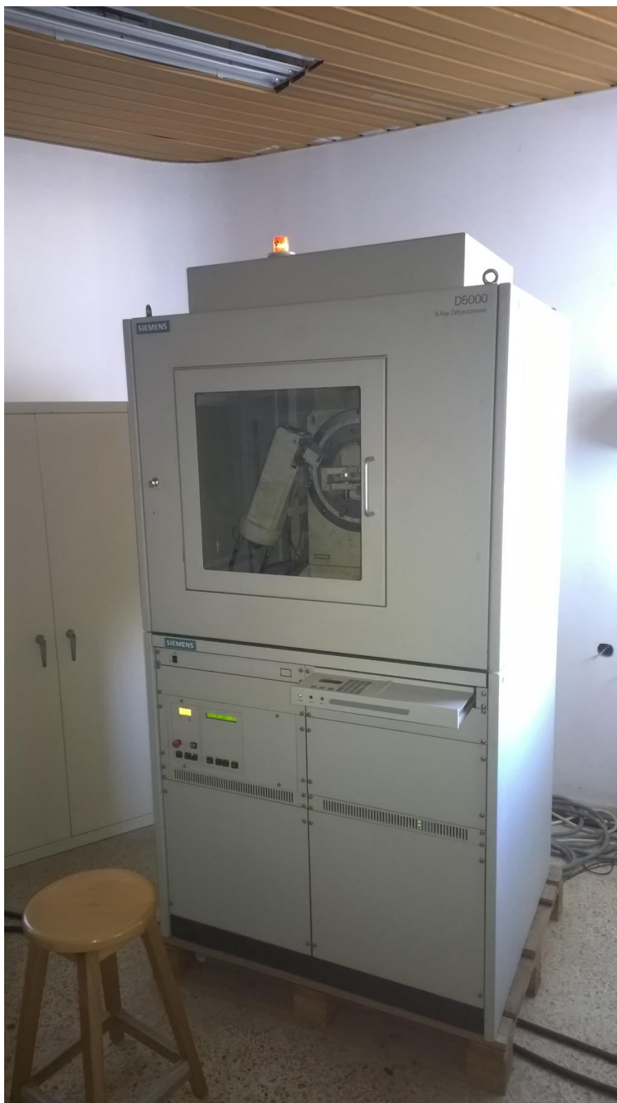
ΕΙΚΟΝΑ 6.1.1 ΧΡΔ ΕΤΑΙΡΙΑΣ SIEMENS, ΜΟΝΤΕΛΟ D 5000 ΣΤΟ ΕΡΓΑΣΤΗΡΙΟ ΧΗΜΙΚΩΝ ΜΗΧΑΝΙΚΩΝ ΤΟΥ ΕΜΠ
