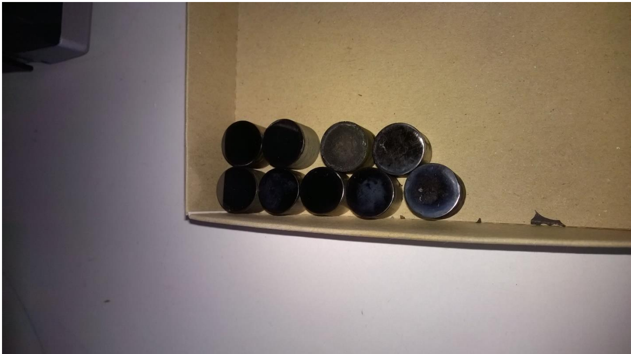
ΕΙΚΟΝΑ 6.1.2 ΦΩΤΟΦΡΑΦΙΑ ΤΩΝ ΔΟΚΙΜΙΩΝ ΝΙΚΕΛΙΟΥ ΕΠΙΣΤΡΩΜΕΝΑ ΜΕ ΛΕΠΤΟ ΥΜΕΝΙΟ ΣΕΛΗΝΙΟΥΧΟΥ ΚΑΔΜΙΟΥ ΚΑΙ ΛΕΠΤΗ ΕΠΙΣΤΡΩΣΗ NANOFLOWERS ΘΕΙΔΙΟΥ ΤΟΥ ΨΕΥΔΑΡΓΥΡΟΥ
