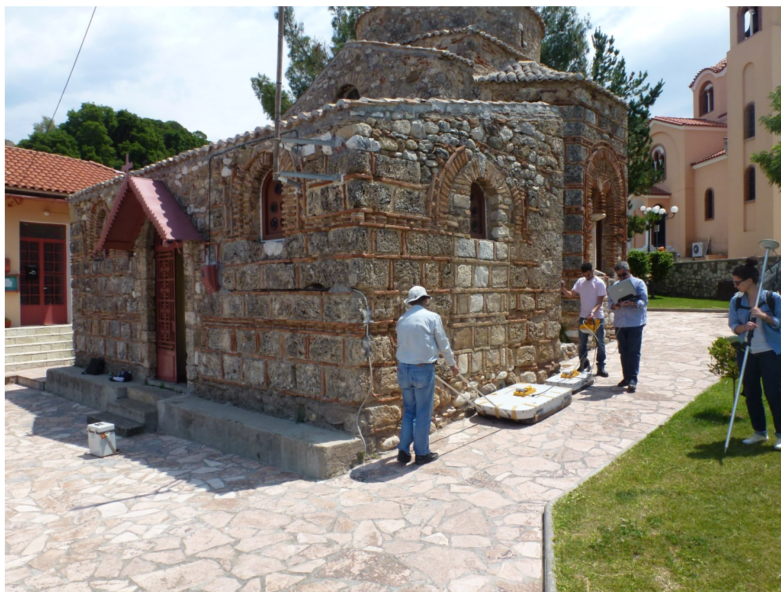
Σχήμα 4.34: Λήψη μετρήσεων με γεωραντάρ (GPR1)
