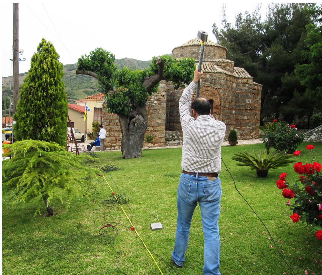
Σχήμα 4.25: Σεισμικές Μετρήσεις Rio-Seis3, διακρίνεται η συστοιχία γεωφώνων και η σεισμική πηγή – σφύρα με πλακίδιο χρούσης.
