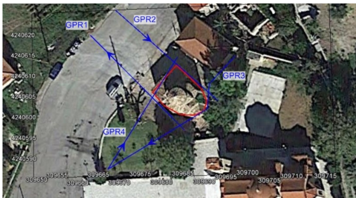
Σχήμα 4.35: Δορυφορική αποτύπωση των τομών GPR με εμφανή τη διεύθυνσή τους
