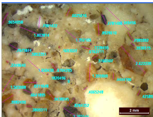
Εικόνα 53 Προσδιορισμός διαμέτρου αδρανών με ψηφιακή επεξεργασία (x20)
