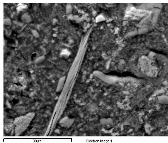
Εικόνα 10-6 Δοκίμιο CF 3/10 μετά την πύρωση σε μεγέθυνση Χ30µm. Παρατηρείται η ανάπτυξη ρωγμών στις επιφάνειες του υαλοθραύσματος-τσιμεντόπαστας.
