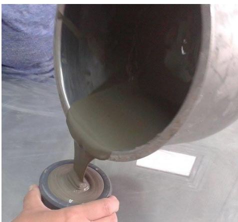
Εικόνα 8 : Εκτέλεση δοκιμών κάθισης.
