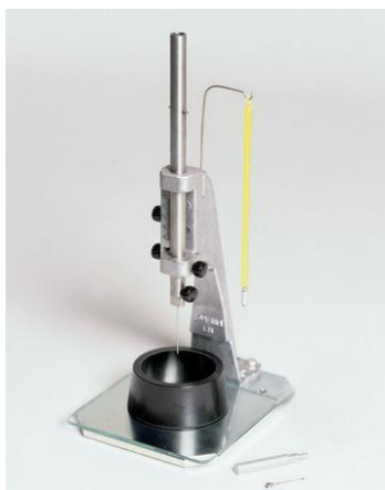
Εικόνα 9 :Πειραματική διάταξη και εκτέλεση του προσδιορισμού χρόνου πήξης.
