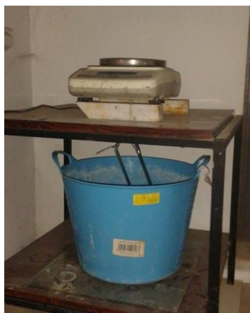
Εικόνα 12: Μέτρηση βάρους υπό αιώρηση.
