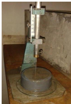
Εικόνα 9 :Πειραματική διάταξη και εκτέλεση του προσδιορισμού χρόνου πήξης.
