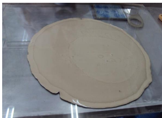
Εικόνα 16: Εκτέλεση δοκιμής χρονικά εξαρτώμενης προσθήκης ρευστοποιητή πάστας P2.
