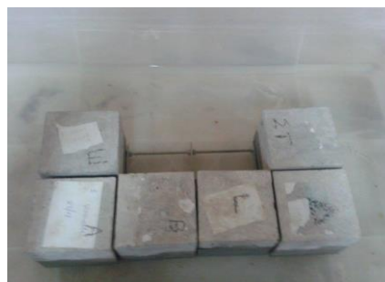
Εικόνα 11: Εκτέλεση μετρήσεων για τον προσδιορισμό της τριχοειδούς απορρόφησης.
