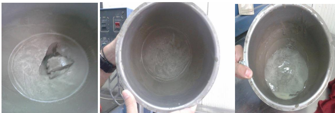
Εικόνα 15: Εκτέλεση δοκιμής χρονικά εξαρτώμενης προσθήκης ρευστοποιητή πάστας P2.
