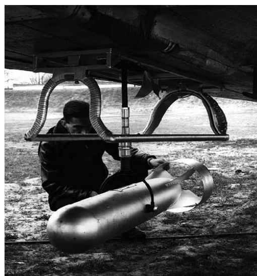
Σχήμα 2-1 Το πρώτο αερομεταφερόμενο μαγνητόμετρο [www.uh.edu].
