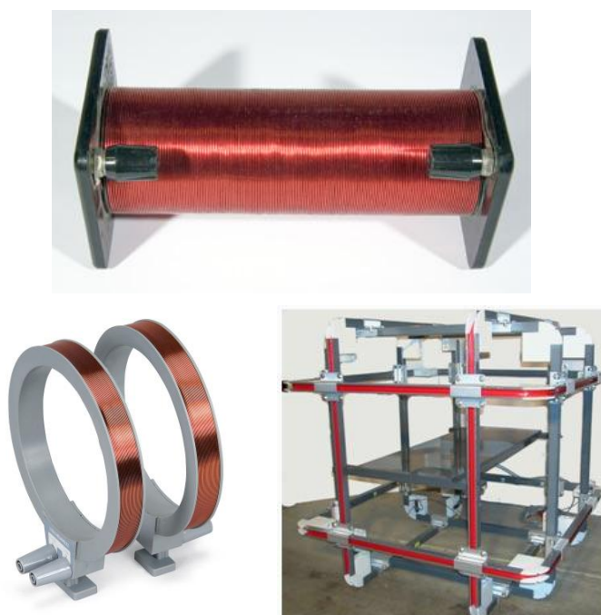
Σχήμα 3-22 Πάνω: σωληνοειδές πηνίο, Κάτω αριστερά: πηνία Helmholtz, κάτω δεξιά: πηνία Helmholtz τριών αξόνων.
