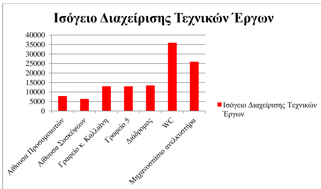
Διάγραμμα 3.3.13 : Ενεργειακές καταναλώσεις kWh/m 2 ισόγειου κτιρίου Διαχείρισης Τεχνικών Έργων Σχολής Πολιτικών Μηχανικών ανά είδος χώρου
