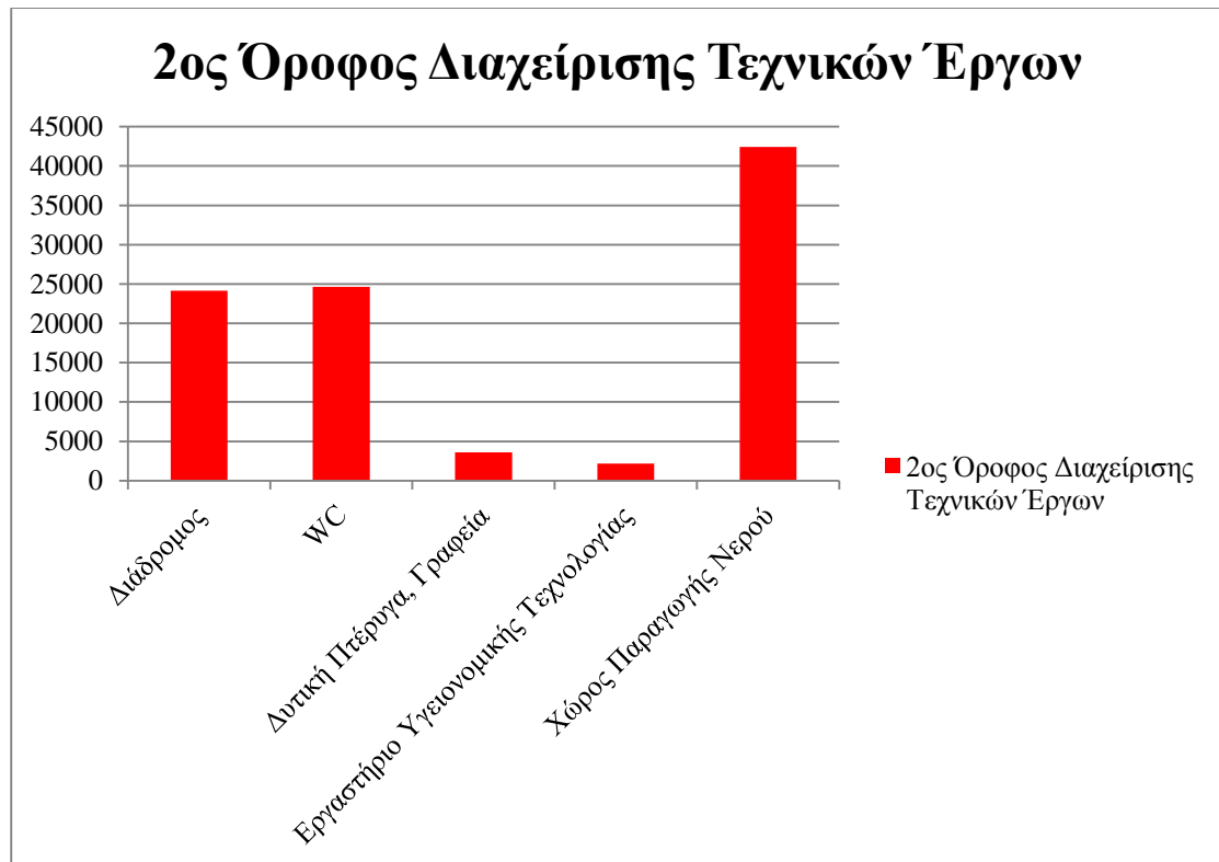
Διάγραμμα 3.3.15 : Ενεργειακές καταναλώσεις kWh/m 2 2 ου Ορόφου κτιρίου Διαχείρισης Τεχνικών Έργων Σχολής Πολιτικών Μηχανικών ανά είδος χώρου
