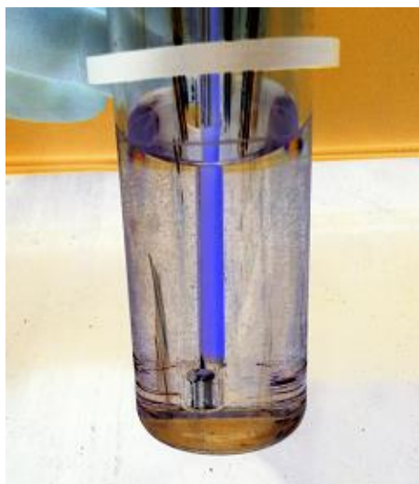
Εικόνα 18: Η διαχωρισμένη αιθανόλη στο μίγμα eth4, ενώ έχει επιστρέψει σε θερμοκρασία δωματίου, εμφανίζεται ως σταγονίδια που στην εικόνα φαίνονται ως μαύρες κουκίδες.
