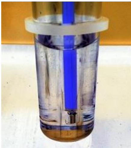
Εικόνα 19: Η διαχωρισμένη αιθανόλη στο μίγμα eth3 που εμφανίζεται στην εικόνα ως μαύρες κουκίδες.
