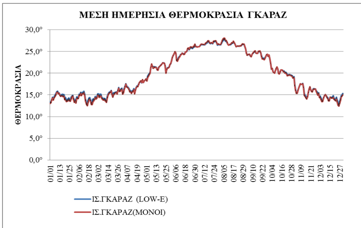
Διάγραμμα 40: Συγκριτικό διάγραμμα μέσων θερμοκρασιών με μονούς υαλοπίνακες και υαλοπίνακες Low-E γκαράζ
