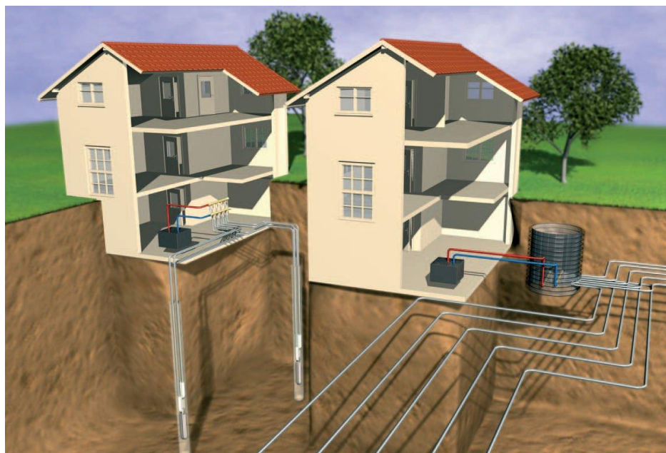
Εικόνα 8: Συστήματα οριζόντιου και κατακόρυφου γεωεναλλακτή
