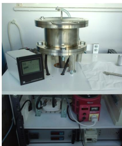
Σχήμα 3.2: (α) Σχηματική αναπαράσταση συστήματος χημικής εναπόθεσης από ατμό με θερμαινόμενο νήμα, (β) εικόνα του συστήματος HW-CVD και (γ) εικόνα του εσωτερικού του αντιδραστήρα.
