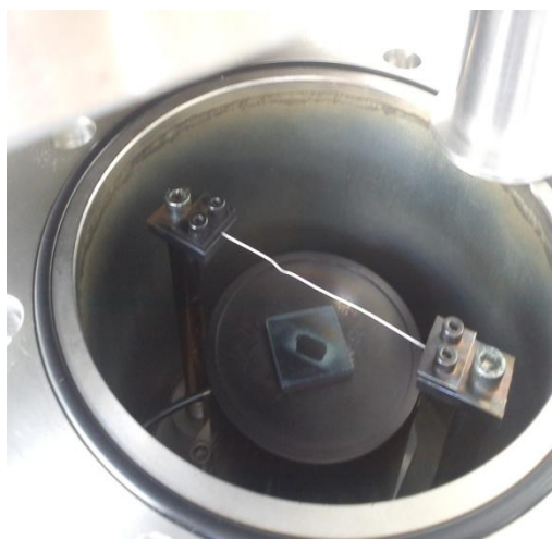
Σχήμα 3.2: (α) Σχηματική αναπαράσταση συστήματος χημικής εναπόθεσης από ατμό με θερμαινόμενο νήμα, (β) εικόνα του συστήματος HW-CVD και (γ) εικόνα του εσωτερικού του αντιδραστήρα.
