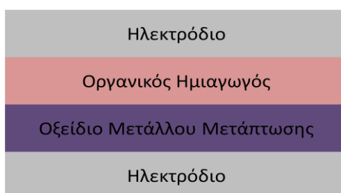
Σχήμα 2.8: Σχηματική αναπαράσταση της τροποποίησης της διεπιφάνειας ηλεκτροδίου/οργανικού ημιαγωγού χρησιμοποιώντας οξείδια των μετάλλων μετάπτωσης.
