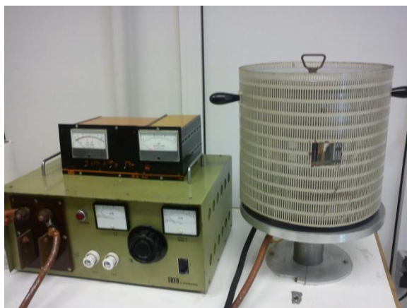
Σχήμα 3.4: Θερμικός εξαχνωτής με τον οποίο γίνεται η εναπόθεση του Αλουμινίου.
