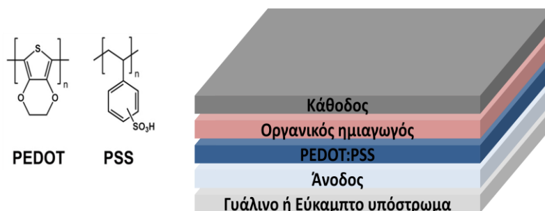
Σχήμα 2.6: Η χημική δομή του πολυμερούς PEDOT:PSS και η σχηματική δομή οργανικής οπτοηλεκτρονικής διάταξης χρησιμοποιώντας το υμένιο PEDOT:PSS ως στρώμα έγχυσης/εξαγωγής οπών.
