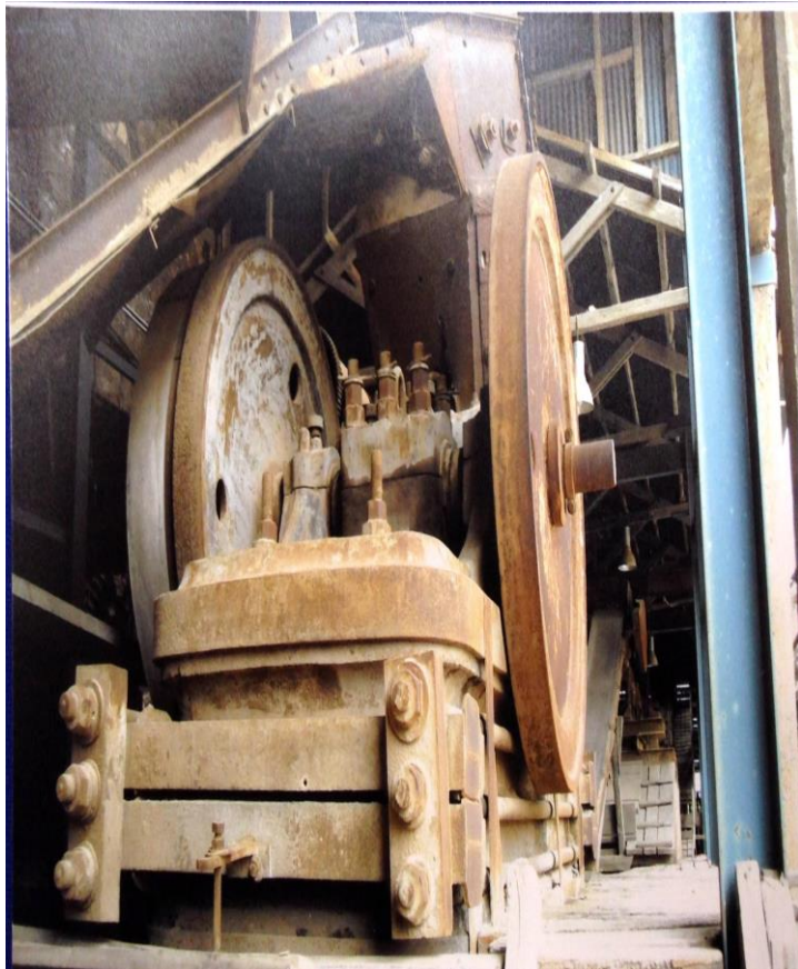
Εικ.11. Φωτογραφική απεικόνιση του θραυστήρα με σιαγόνες, τύπου Humboldt της ΓΕΜΑ.
